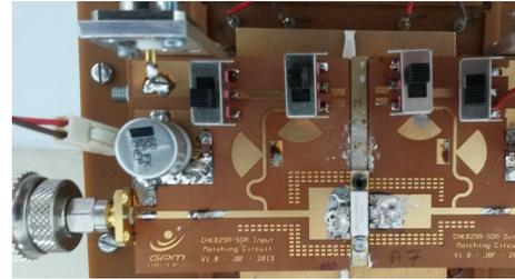
FIGURE 4.4 – Image d'un amplificateur après vieillissement.
