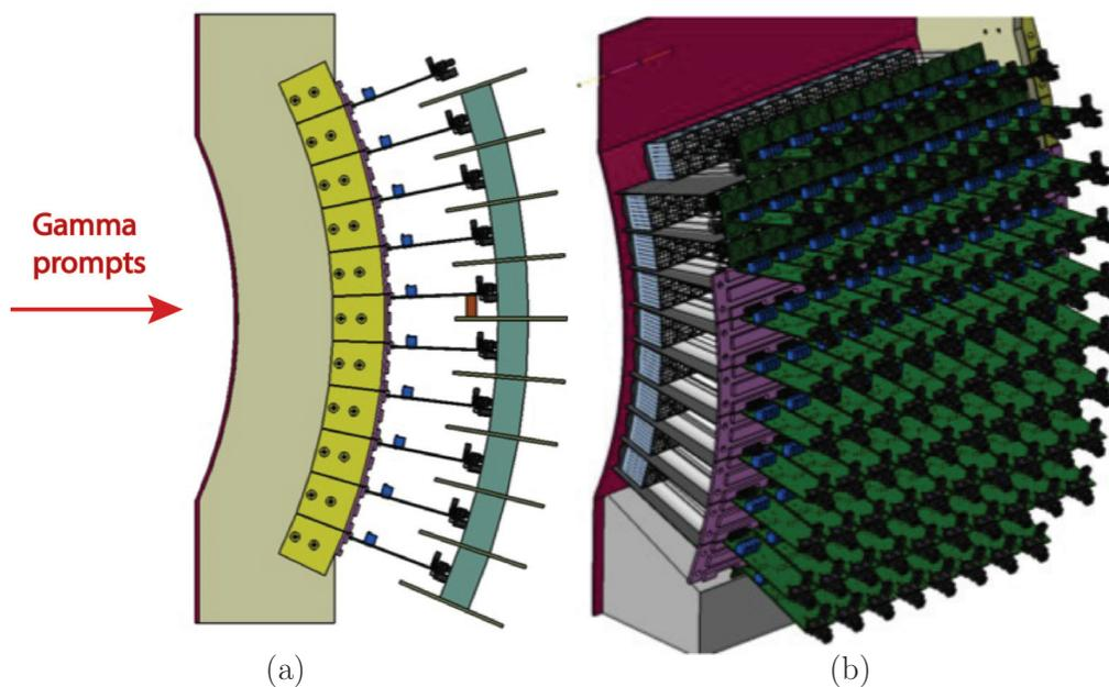
FIGURE 4.25 – Vue latérale (a) et vue générale arrière (b) de la structure mécanique développée pour l’absorbeur. Les blocs de BGO ne sont pas représentés sur la figure de gauche et les PM ne sont pas affichés sur la figure de droite. Les cartes de pont diviseur sont affichées quant à elles en vert. Vues fournies par le service mécanique du LPC Clermont-Ferrand.
