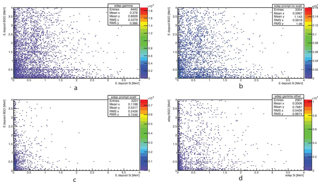
FIGURE 2.17 – Spectre 2D de l'énergie déposée dans l'absorbeur en fonction de l'énergie déposée dans un plan de diffuseur silicium sans coupure en énergie et pour une statistique de  $10^8$  protons incidents. (a) événements *true gamma*, (b) photons gamma prompts sans diffusion dans la cible, (c) photons gamma prompts ayant diffusé dans la cible en PMMA, (d) photons d'autres processus.
