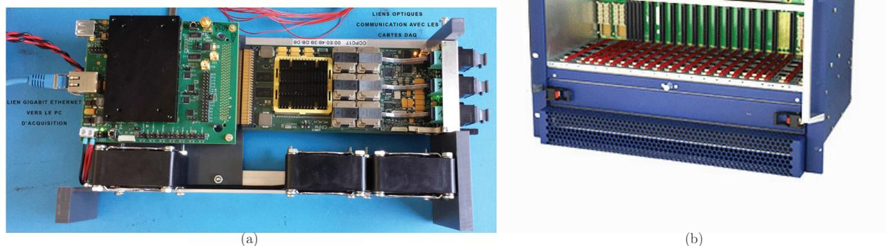
FIGURE 4.30 – La figure de gauche est une photo de la carte AMC40. Les données des cartes DAQ arrivent depuis la droite via des liens optiques et un câble gigabit ethernet ressort sur la gauche vers le PC d’acquisition. Cette carte AMC40 va se connecter dans un *crate*  $\mu$ -TCA (figure de droite).
