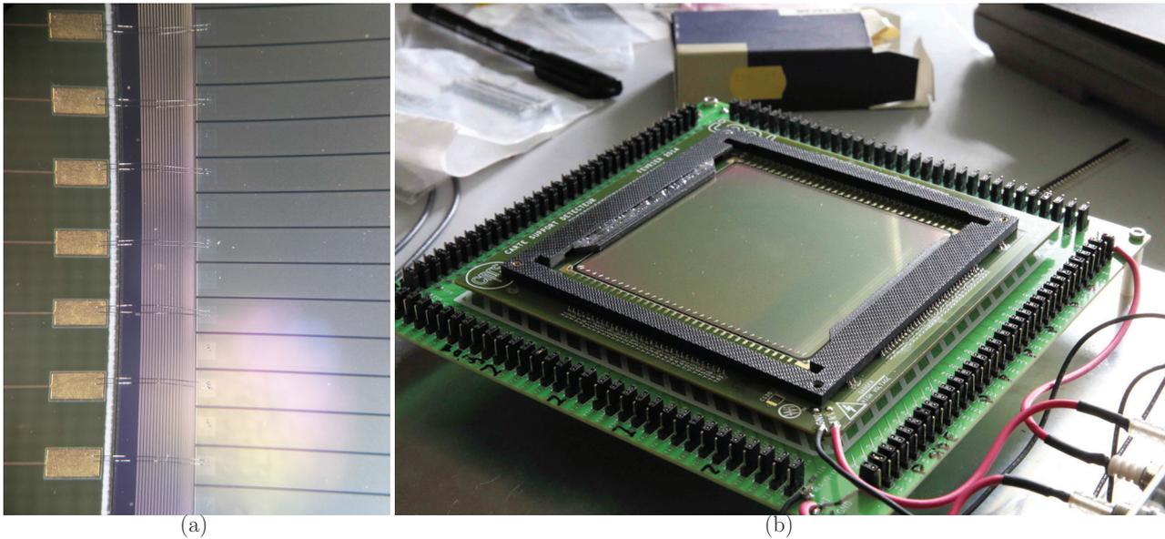
FIGURE 4.2 – À gauche se trouve une photo du *bonding* réalisé entre les pistes du détecteur silicium et la carte mezzanine PCB supportant le détecteur. Les pistes du silicium se trouvent à droite et les plots d'accueil sur le PCB se trouvent à gauche. Les anneaux de garde se situent en dessous des *bondings*. Une photo du détecteur silicium sur sa carte support et une carte test pour la mesure de courant de fuite est présentée.
