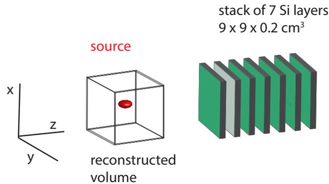
FIGURE 3.4 – Volume reconstruit autour du point source d'émission des photons gamma.
