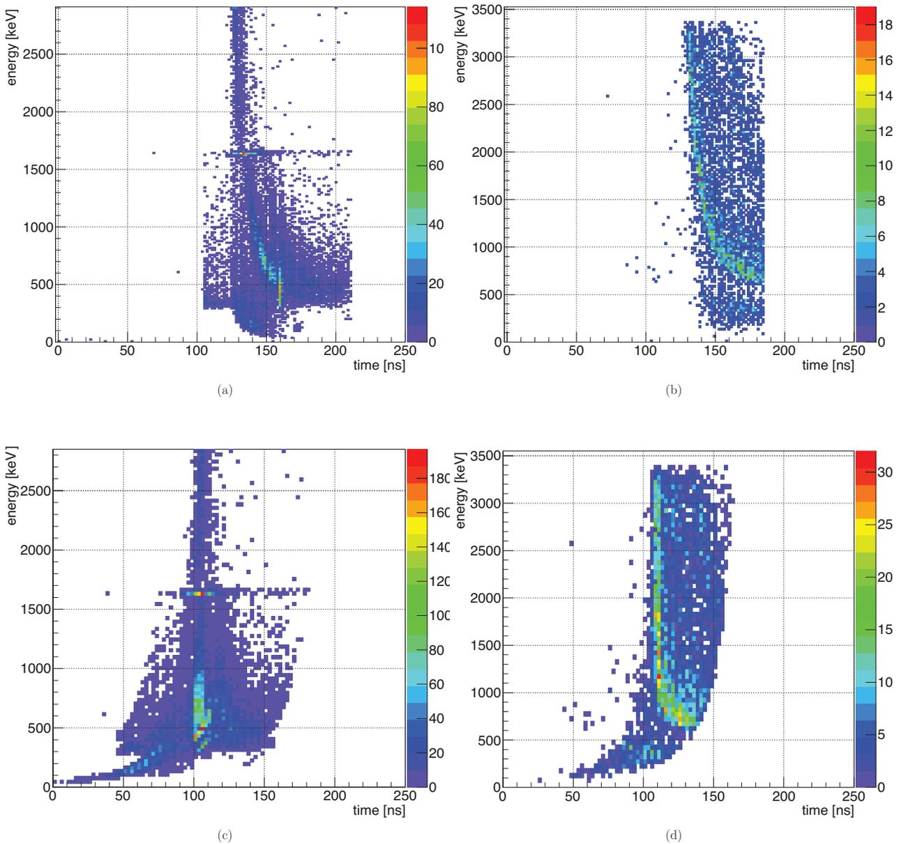
FIGURE 5.13 – Spectre en temps en fonction de l'énergie déposée de la piste N5 (figures (a) et (c)) et P5 (figures (b) et (d)). Les spectres (a) et (b) sont sans correction du *time walk* et les spectres (c) et (d) sont quant à eux corrigés. Une coupure en énergie est effectuée pour les pistes N au niveau des évènements dus au *reset* de l'ASIC V2 des pistes P. Les spectres sont obtenus pour une acquisition avec le faisceau d'ions et la configuration expérimentale 2 à intensité maximale.
