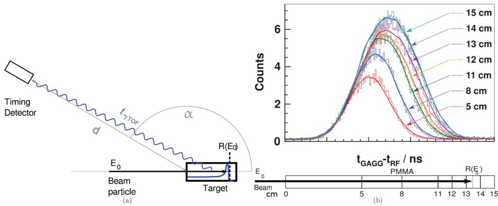
FIGURE 1.11 – (a) Schéma du dispositif expérimental mis en place par Golnik et al. pour réaliser leurs mesures de temps de vol sur une cible homogène au centre KVI-CART (université de Groningen).
