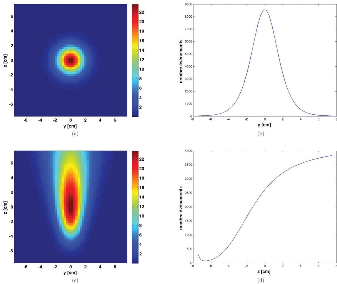
FIGURE 3.16 – Reconstructions 2D de la position de la source pour le plan  $(x,y)$  (a) parallèle à la caméra et le plan perpendiculaire  $(y,z)$  (c). Les profils associés sont les projections des événements reconstruits de tout le volume sur l'axe  $y$  (b) et sur l'axe  $z$  (d). Les résultats correspondent à 15 itérations pour des photons monoénergétiques de 100 keV.
