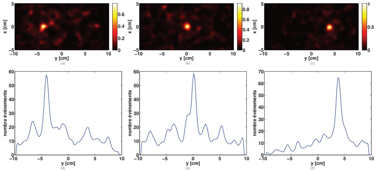
FIGURE 2.21 – Reconstruction LM-MLEM de la source ponctuelle polyénergétique en 2D pour le plan  $(x,y)$  avec les projections des évènements reconstruits de tout le volume sur l'axe  $y$  associées. La source est placée en  $y = -40$  mm ((a) et (d)),  $y = 0$  mm ((b) et (e)) et  $y = +40$  mm ((c) et (f)). Les reconstructions correspondent à  $10^7$  photons émis sur  $2\pi$  stéradians avec environ 2500 évènements reconstruits. Les résultats sont présentés pour 20 itérations.
