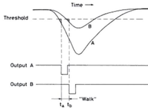
FIGURE 5.8 – Schéma montrant le *time walk* entre deux signaux arrivant en même temps, mais possédant deux hauteurs d'impulsions différentes. Le *threshold* correspond au seuil appliqué par le discriminateur.
