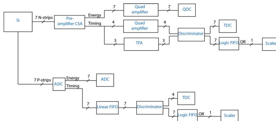
FIGURE 4.15 – Schéma de la chaîne d'acquisition utilisée pour caractériser le détecteur silicium. La partie concernant le scintillateur  $\text{LaBr}_3$  et la partie de câblage de la coïncidence entre les deux détecteurs ne sont pas explicitées ici.
