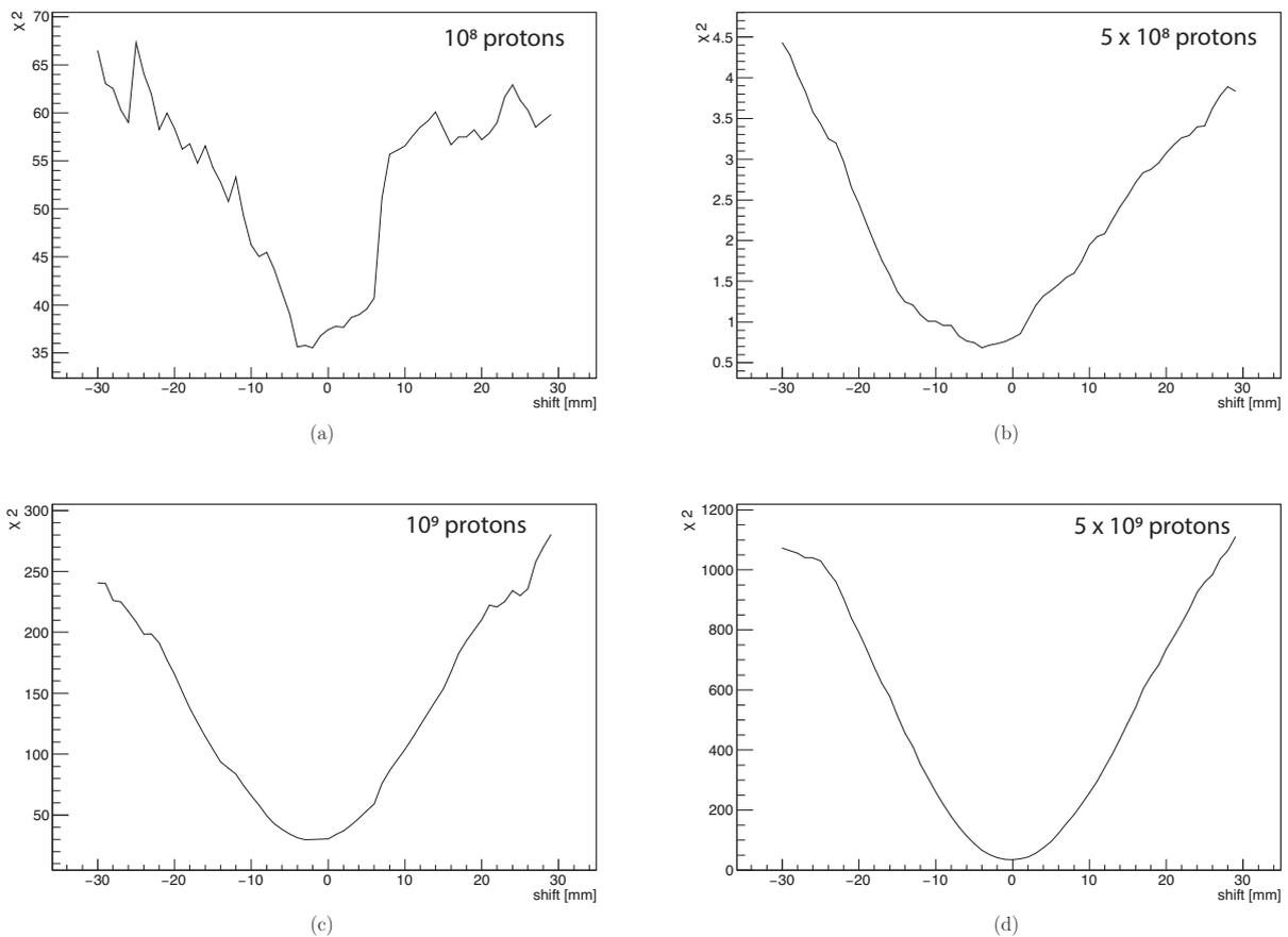
FIGURE 2.27 – Valeurs du  $\chi^2$  en fonction de la valeur du décalage du profil NURBS par rapport à sa position initiale [30,70] mm. Valeurs données pour différentes statistiques du profil échantillonné :  $10^8$  (a),  $5 \times 10^8$  (b),  $10^9$  (c) et  $5 \times 10^9$  (d).
