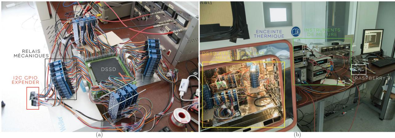
FIGURE 4.10 – Photo du détecteur silicium sur son PCB support et le tout connecté à la carte test (a). Les relais mécaniques sont reliés à la carte de test par des câbles *jumper*. Les relais sont au nombre de 8 sur une carte support et il y a 4 cartes mises ensemble par côté du détecteur. La photo de droite donne une vue d'ensemble du dispositif expérimental avec l'enceinte thermique où se trouve le détecteur silicium, les appareils de mesures, le Raspberry Pi et l'ordinateur d'acquisition.
