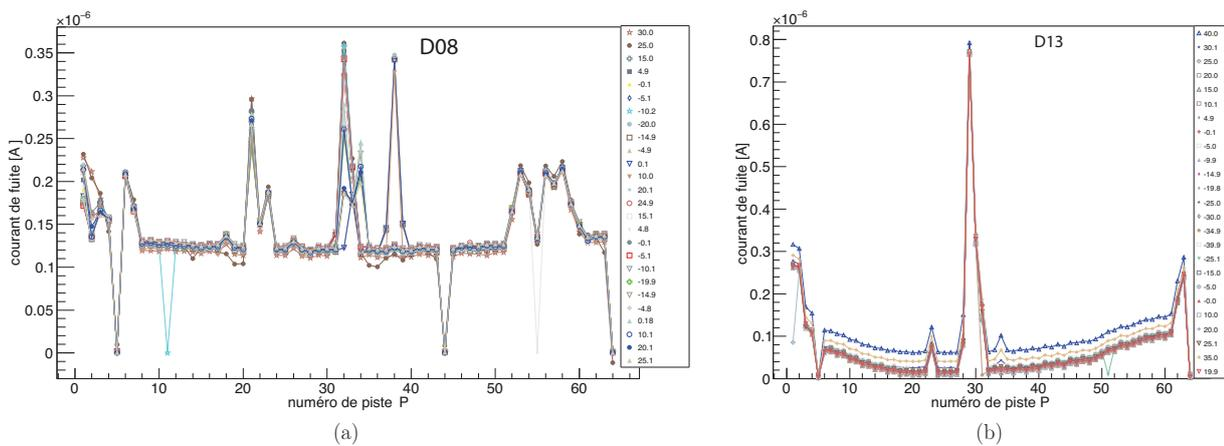
FIGURE 4.12 – Courants de fuite des pistes P pour les détecteurs D08(a) et D13(b). Mesures pour des températures de  $+40^\circ\text{C}$  et  $-40^\circ\text{C}$  dans une enceinte thermique avec une stabilisation d'une heure avant chaque température.
