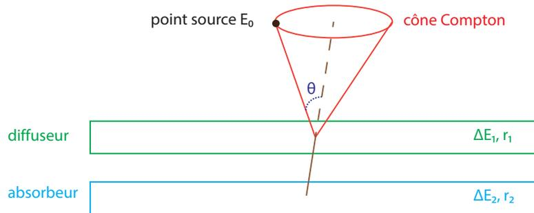
FIGURE 1.12 – Représentation de la diffusion Compton d'un photon dans la caméra Compton. La position d'émission du photon est estimée sur le cône Compton ayant une ouverture  $\theta$  définie par l'angle de diffusion Compton du photon.
