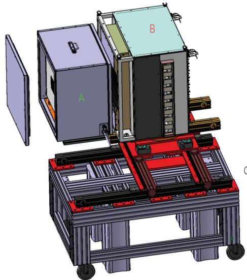
FIGURE 4.29 – Modélisation de la caméra Compton avec l’ensemble des développements mécaniques intégrés. Le diffuseur est modélisé en A, l’absorbeur est modélisé en B et la table de positionnement avec les axes de translation sont modélisés en C.
