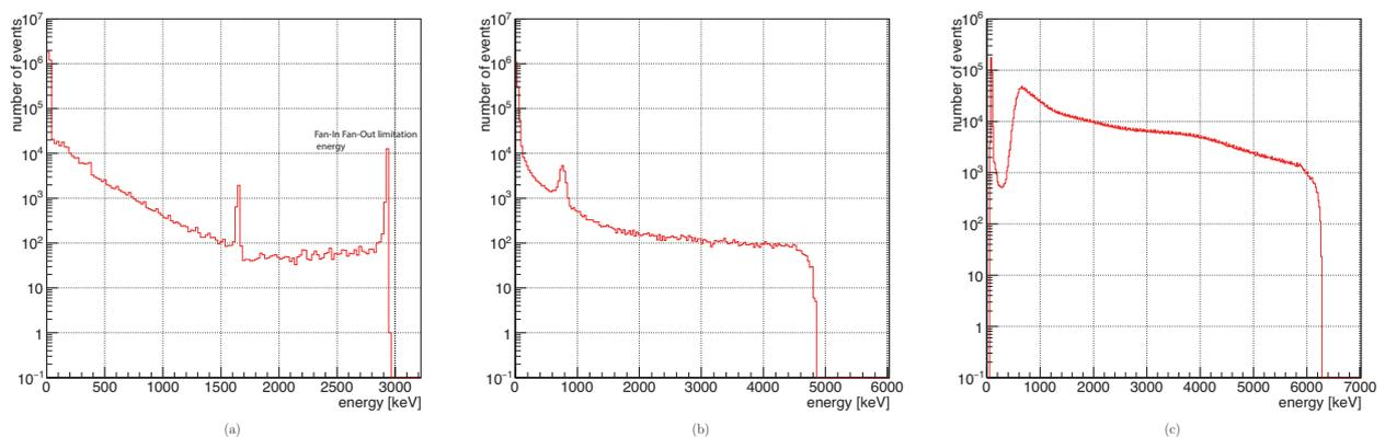
FIGURE 5.10 – Spectres en énergie pour la piste N5 (a), la piste P6 (b) et le signal *BGO sum* (c). Les axes des ordonnées sont en échelle logarithmique. Spectres obtenus pour une acquisition avec la configuration expérimentale 1 et une intensité du faisceau d'ions maximale.
