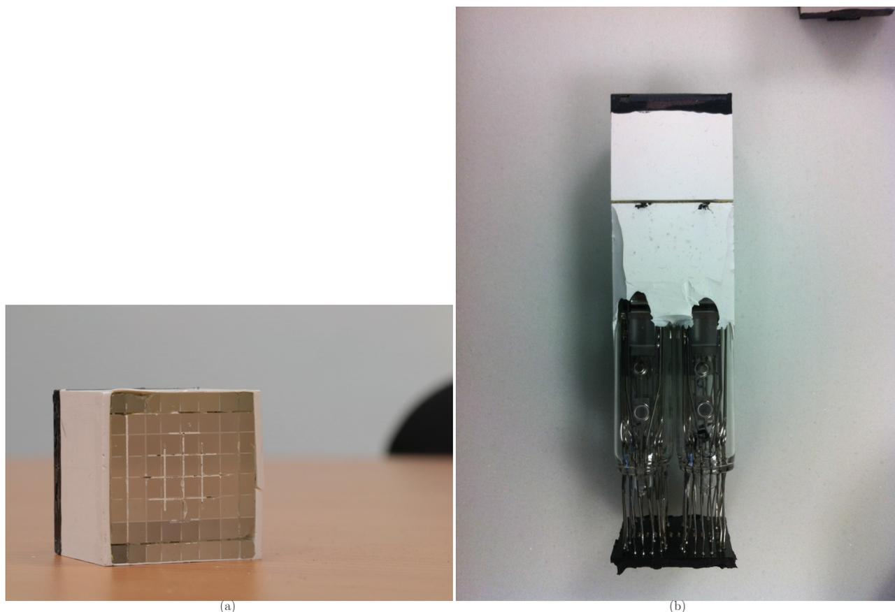
FIGURE 4.23 – Photo d’un bloc scintillateur de BGO (a). La matrice de  $8 \times 8$  pixels formée par les stries dans le scintillateur peut être facilement distinguée. La photo de droite (b) montre le bloc scintillateur couplé par collage au système d’amplification du signal, composé de 4 tubes photomultiplicateurs, avant le reconditionnement et le ré-appariement des PM.
