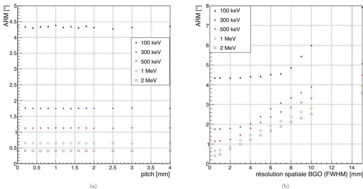
FIGURE 3.7 – Résolution angulaire en fonction de la résolution spatiale du silicium (a) et du BGO (b). La résolution spatiale du silicium est définie par le *pitch* entre les pistes du détecteur. Étude pour cinq énergies de photons incidents monoénergétiques : 100 keV, 300 keV, 500 keV, 1 MeV et 2 MeV. Les détecteurs sont considérés parfaits hormis la résolution spatiale et l'effet Doppler.
