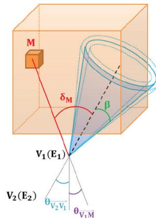
FIGURE 1.14 – Représentation d'un évènement reconstruit avec l'algorithme LM-MLEM. Le voxel  $M$  représente un voxel du volume reconstruit.  $V_1$  représente le point d'interaction du photon dans le diffuseur et  $V_2$  représente le point d'interaction dans l'absorbeur.  $\beta$  est l'angle de diffusion Compton calculé à partir des énergies déposées dans la caméra.
