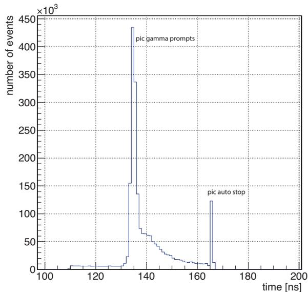
FIGURE 5.15 – Spectre en temps du signal *BGO sum*. Aucune coupure en énergie n'est effectuée. Le spectre est acquis avec le faisceau d'ions carbone à intensité maximale et avec la configuration expérimentale 2.
