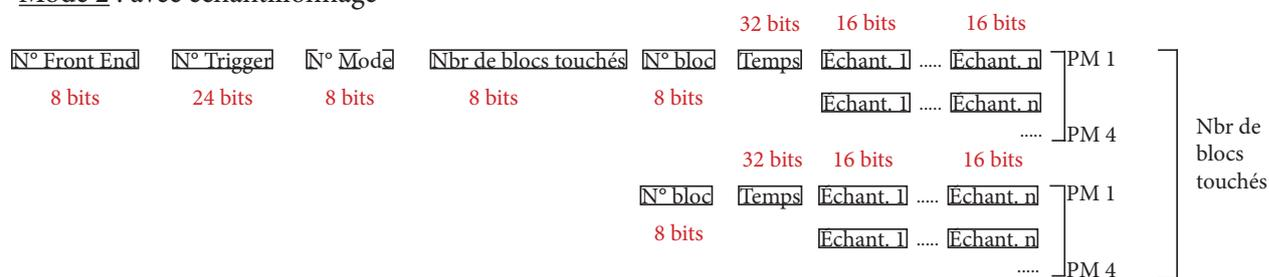
FIGURE 4.33 – Format des données envoyées par l’absorbeur.
