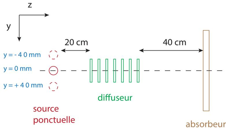
FIGURE 2.20 – Schématisation du dispositif simulé pour une source ponctuelle placée en  $y = 0$  mm,  $y = -40$  mm et  $y = +40$  mm. Le diffuseur est placé à 20 cm de la source ponctuelle et l'absorbeur à 40 cm du diffuseur. Le schéma n'est pas à l'échelle.
