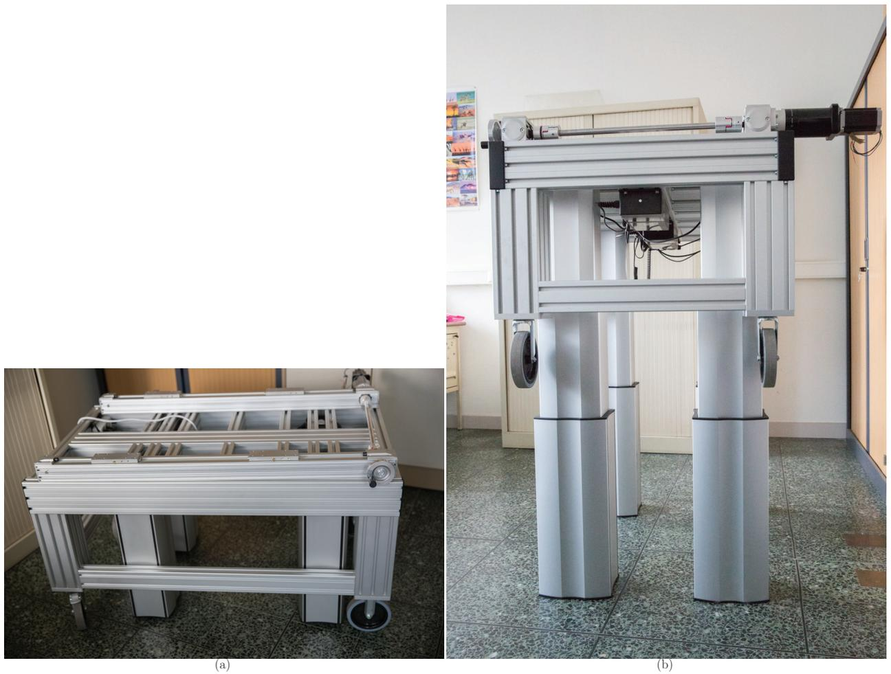
FIGURE 4.27 – (a) Table de positionnement abaissée au maximum. (b) Table en position haute maximale. Le premier des axes de translation est visible sur la table.
