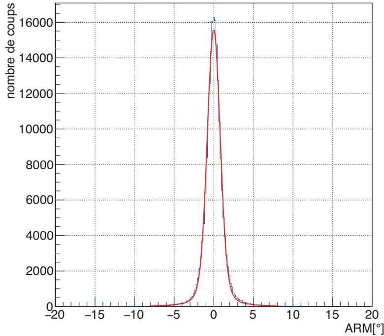
FIGURE 3.3 – Distribution de l'ARM pour des photons de 1 MeV détectés dans la caméra Compton. Le dispositif de simulation est celui de référence. La résolution angulaire est donnée comme la largeur à mi-hauteur de cette distribution. La courbe rouge correspond à l'ajustement Voigt réalisé sur la distribution (en bleu).
