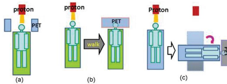
FIGURE 1.7 – Schéma de trois systèmes disponibles pour effectuer un contrôle du parcours des ions en clinique avec la TEP. Le schéma (a) représente la solution *in-beam*, le schéma (b) la solution *off-line* et le schéma (c) la solution *in-room* [Zhu and Fakhri, 2013].
