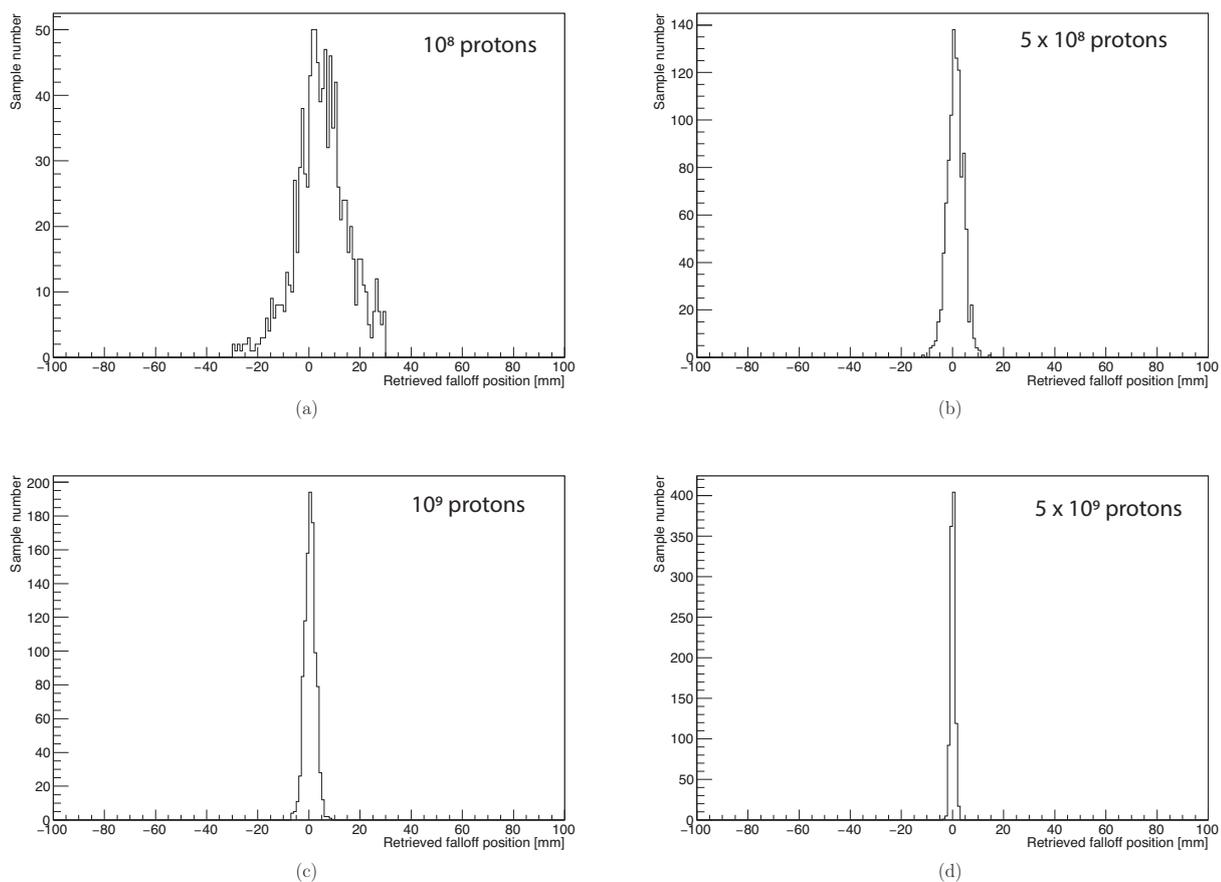
FIGURE 2.28 – Distribution des décalages correspondant aux valeurs minimales de  $\chi^2$  trouvées pour 1000 échantillons avec une statistique de protons incidents donnée. Le nombre de protons incidents modélisé est :  $10^8$  (a),  $5 \times 10^8$  (b),  $10^9$  (c) et  $5 \times 10^9$  (d). La largeur à mi-hauteur des distributions renseigne sur la précision de la caméra Compton atteinte pour le nombre de protons incidents associé.
