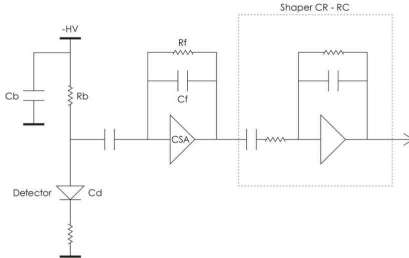
FIGURE 4.8 – Schéma du détecteur silicium et de la chaîne d'acquisition analogique (ASIC). La résistance de polarisation est repérée par  $R_b$ , la capacité de découplage par  $C_b$ , la capacité du détecteur par  $C_d$ , la résistance et la capacité de contre réaction du préamplificateur de charges par respectivement  $R_f$  et  $C_f$ . Pour les mesures de courant de fuite, la capacité de découplage  $C_b$  est retirée et remplacée par une résistance.
