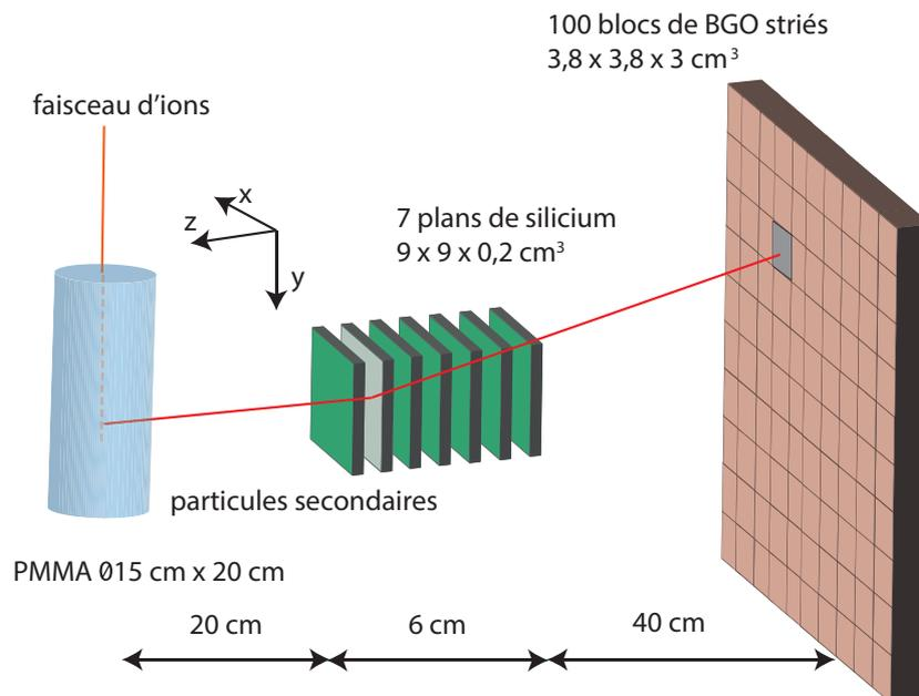
FIGURE 2.1 – Modélisation du patient avec le cylindre en PMMA ainsi que de la caméra Compton. C’est dans cette configuration que sont obtenus les résultats présentés ci-après.
