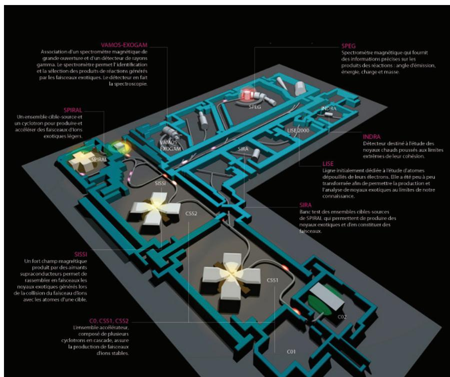
FIGURE 5.1 – Représentation du GANIL avec sa partie accélération des ions (C01 et C02) et sa partie salles d'expérience. La salle d'expérience utilisée est située tout en haut à gauche du centre (à côté de l'expérience SPEG). Source <http://www.ganil-spiral2.eu>.
