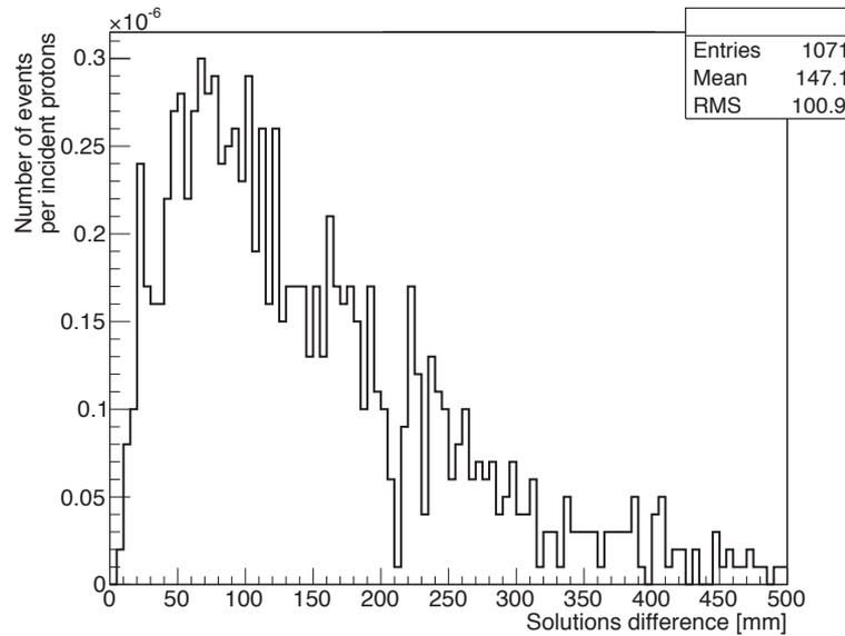
FIGURE 2.12 – Distance entre les deux solutions données par la méthode de reconstruction ligne-cône pour un faisceau de protons et une statistique de  $10^8$  protons incidents. L'intensité du faisceau de protons est réduite à 1 proton/paquet et la coupure en temps de vol est appliquée. La courbe noire représente l'ensemble des coïncidences reconstruites sur tout le volume de la cible cylindrique en PMMA.
