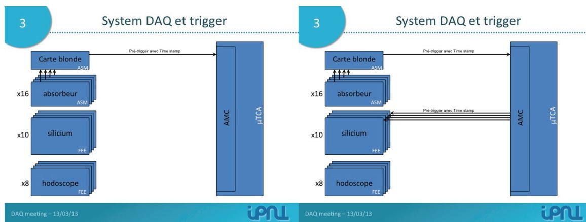
(c) Génération du trigger par une des cartes silicium. (d) Distribution du trigger à l'ensemble des détecteurs.
