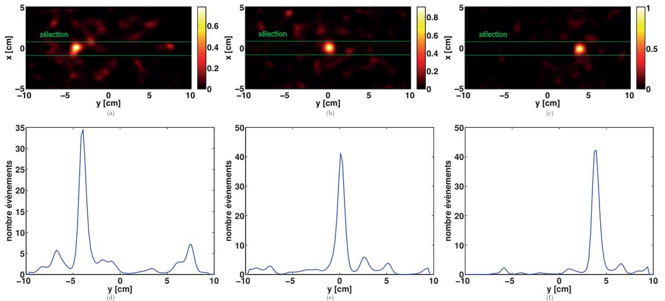
FIGURE 2.22 – Reconstruction LM-MLEM de la source ponctuelle polyénergétique en 2D pour le plan  $(x,y)$  avec les projections des évènements reconstruits de tout le volume sur l'axe  $y$ . Mêmes évènements reconstruits que pour la figure 2.21 mais avec une sélection des évènements suivant l'axe  $x$  à  $x = 0 \pm 10$  mm.
