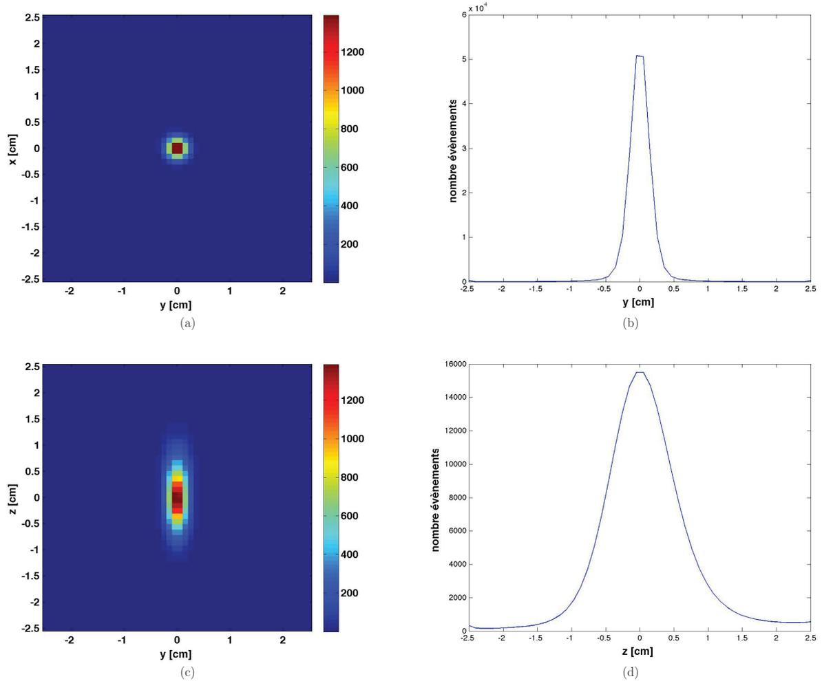
FIGURE 3.17 – Reconstructions 2D de la position de la source pour le plan  $(x, y)$  (a) parallèle à la caméra et le plan perpendiculaire  $(y, z)$  (c). Les profils associés sont les projections des événements reconstruits de tout le volume sur l'axe  $y$  (b) et sur l'axe  $z$  (d). Les résultats correspondent à 15 itérations pour des photons monoénergétiques de 1 MeV.
