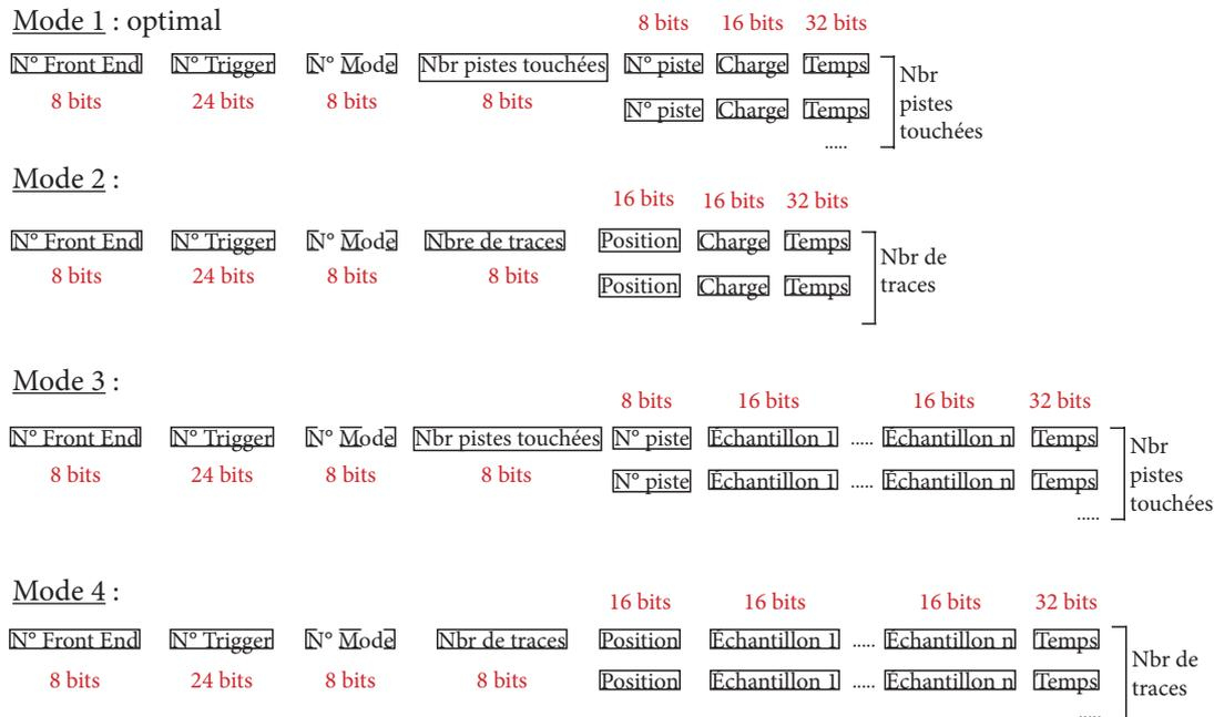
FIGURE 4.32 – Formats des données envoyées par les plans de détecteur silicium.
