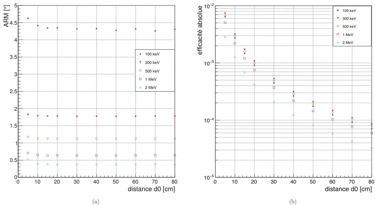
FIGURE 3.11 – Variation de la résolution angulaire (a) et de l'efficacité de détection de la caméra Compton (b) en fonction de la distance source – 1<sup>er</sup> plan de détecteur silicium. Résultats pour des énergies de photons gamma de 100 keV, 300 keV, 500 keV, 1 MeV et 1,5 MeV.
