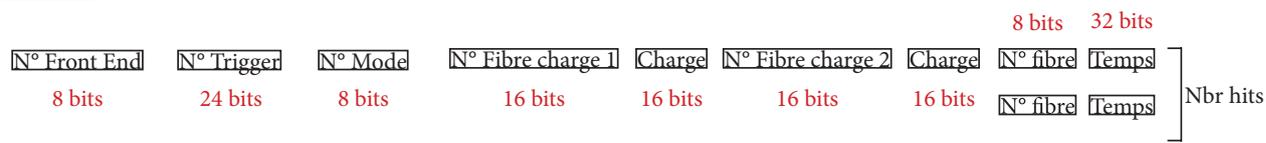
FIGURE 4.34 – Format des données envoyées par l’hodoscope.
