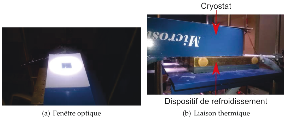
FIGURE 3.11 – Zoom sur la fenêtre optique du dispositif de mesure de la température de fonctionnement d'une cellule photovoltaïque en fonction de la polarisation sous éclairage AM1.5G (a) et zoom sur la liaison thermique du dispositif entre le cryostat et le système de refroidissement.
