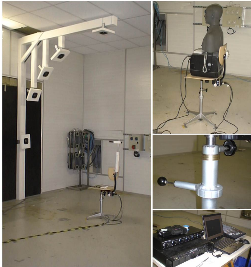
FIGURE B.2: Parties du dispositif expérimental mis en place pour les mesures des réponses impulsionnelles binaurales.
