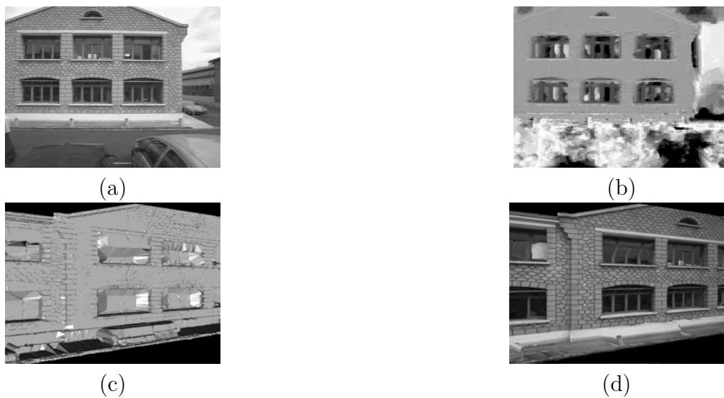
FIGURE 1.14 – Différentes étapes de la méthode de modélisation proposée dans [PPPD05] : (a) Image de façade; (b) Image de profondeurs; (c) Modèle par maillage; (d) Modèle texturé
