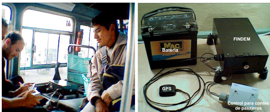
Photo 12 – A gauche, en juillet 2002, recueil des données (coordonnées géographiques et nombre de passagers) à bord d'un bus à Quito avec l'appareil FINDEM, présenté à droite (clichés : W. Sutter et F. Demoraes)
