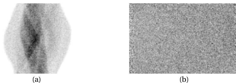
FIGURE 1.26 – Sinogrammes des (a) coïncidences vraies et (b) coïncidences fortuites. La répartition de coïncidences fortuites est quasiment uniforme et ne semble pas être corrélée avec le sinogramme des coïncidences vraies.
