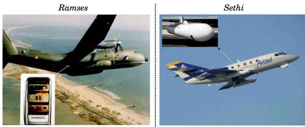
Figure 0.1 – Photographies des deux derniers systèmes RADAR de l'ONERA avec leur porteur. A gauche le système RADAR RAMSES installé sur un transall de l'armée. A droite le système SETHI installé sur un falcon 20. Remerciements à Pascale Dubois-Fernandez pour l'autorisation de publication de ces photographies.
