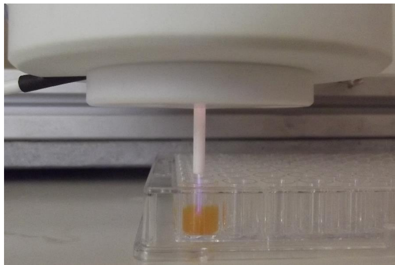
Figure 2.8. Réacteur R1 traitant des liposomes. Conditions de la manip: V_{pp}=11.5 kV, f=10 kHz et Q=2 slm.
