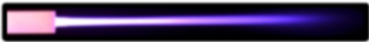
Figure 4.11. Intensité de l'émission optique des espèces excitées prédominantes en fonction de la distance à partir de l'orifice du tube. La résolution spatiale (largeur de la zone) est de 2 mm tandis que chaque spectre représente la valeur moyenne de deux expériences indépendantes. Conditions de manips: V_{cc}=11 kV, f=10 kHz et Q=2 slm.
