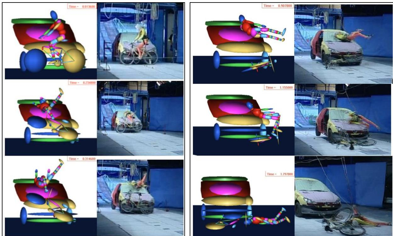
Figure 100. Comparaison des cinématiques entre l'essai expérimental et la simulation numérique
