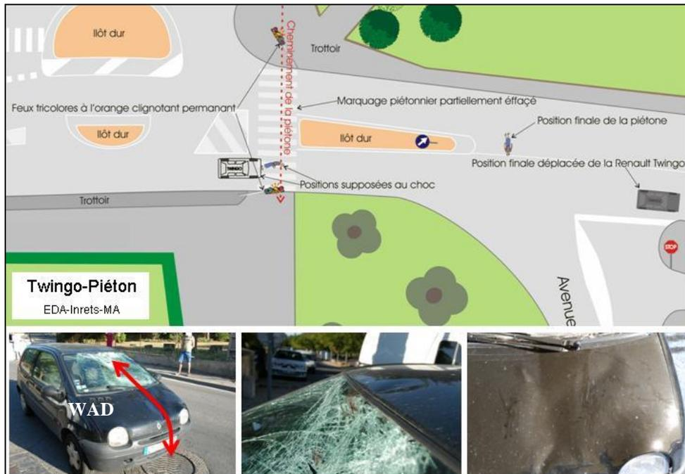
Figure 89. Accident n°1, plan de l'accident, impacts sur la Twingo et WAD (Wrap-Around Distance)
