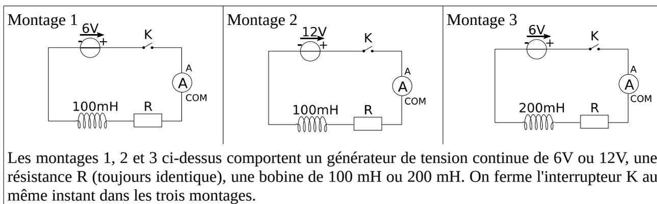
2.1 – Lors de l'établissement du courant, on mesure l'intensité avec l'ampèremètre A **en même temps dans les montages 1 et 2**. Dans le montage 1, l'intensité mesurée par l'ampèremètre A est :
