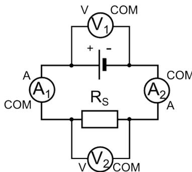
Le montage 1 comporte une pile et une seule résistance  $R_S$ . L'ampèremètre  $A_1$  mesure l'intensité  $I_1$  et l'ampèremètre  $A_2$  mesure l'intensité  $I_2$ . On mesure la tension aux bornes de la pile avec le voltmètre  $V_1$  et la tension aux bornes de la résistance  $R_S$  avec le voltmètre  $V_2$ . Les valeurs mesurées sont positives.
