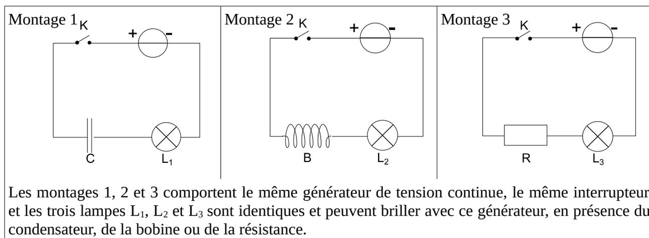
1.1 – On ferme l'interrupteur K au même instant dans les trois montages :
