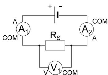
Le montage 1 comporte une pile et une seule résistance  $R_S$ . L'ampèremètre  $A_1$  mesure l'intensité  $I_1$  et l'ampèremètre  $A_2$  mesure l'intensité  $I_2$ . On mesure la tension aux bornes de la résistance  $R_S$  avec le voltmètre  $V_1$ . Les valeurs mesurées sont positives.
