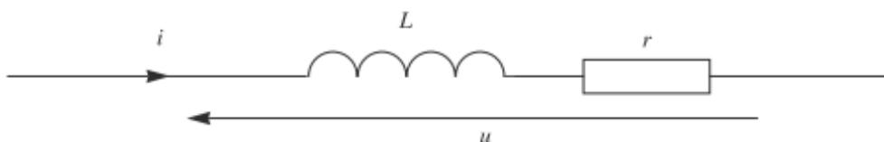
On pourra faire remarquer que l'introduction d'un noyau de fer doux augmente l'inductance d'une bobine. Cependant la validité de la relation  $u = ri + L di/dt$  n'est assurée que pour une bobine sans noyau de fer doux. En travaux pratiques seule l'étude de l'établissement du courant est exigée. On pourra utiliser un oscilloscope à mémoire ou un système d'acquisition de données.
