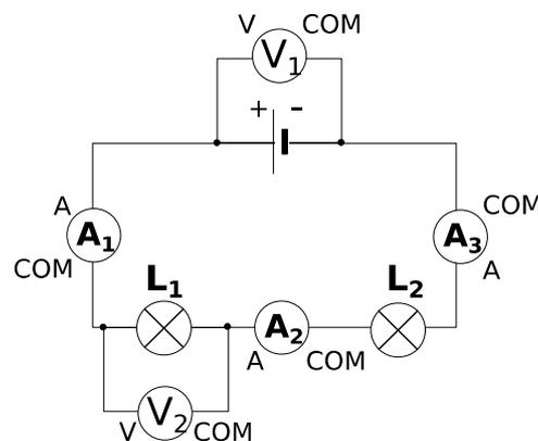
Le montage 2 comporte la même pile et la même lampe L<sub>1</sub> que dans le montage 1. On ajoute la lampe L<sub>2</sub> en série, identique à L<sub>1</sub>. Les ampèremètres A<sub>1</sub>, A<sub>2</sub> et A<sub>3</sub> mesurent les intensités I<sub>1</sub>, I<sub>2</sub> et I<sub>3</sub>. On mesure la tension aux bornes de la pile avec le voltmètre V<sub>1</sub> et aux bornes de la lampe L<sub>1</sub> avec le voltmètre V<sub>2</sub>.
