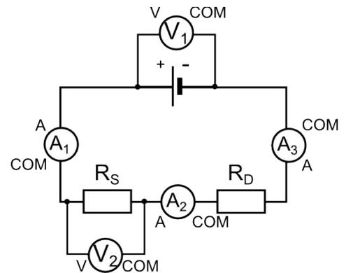
Le montage 2 comporte la même pile et la même résistance  $R_S$  que dans le montage 1. On ajoute la résistance  $R_D$  en série, identique à  $R_S$ . Les ampèremètres  $A_1$ ,  $A_2$  et  $A_3$  mesurent les intensités  $I_1$ ,  $I_2$  et  $I_3$ . On mesure la tension aux bornes de la pile avec le voltmètre  $V_1$  et la tension aux bornes de la résistance  $R_S$  avec le voltmètre  $V_2$ .
