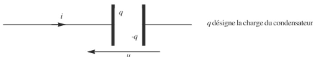
Après avoir rappelé que l'intensité est un débit de charges électriques, on introduira  $i = dq/dt$  uniquement pour le condensateur,  $q$  étant la charge du condensateur à l'instant  $t$ .
