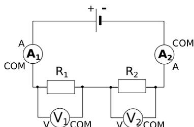
Le montage ci-contre comporte une pile, deux résistances  $R_1$  et  $R_2$ , avec  $R_1 < R_2$ . L'ampèremètre  $A_1$  mesure l'intensité  $I_1$  et l'ampèremètre  $A_2$  mesure l'intensité  $I_2$ . On mesure la tension aux bornes de  $R_1$  avec le voltmètre  $V_1$  et la tension aux bornes de  $R_2$  avec le voltmètre  $V_2$ .
