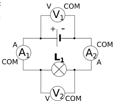
Le montage 1 comporte une pile et une lampe L<sub>1</sub>. L'ampèremètre A<sub>1</sub> mesure l'intensité I<sub>1</sub> et l'ampèremètre A<sub>2</sub> mesure l'intensité I<sub>2</sub>. On mesure la tension aux bornes de la pile avec le voltmètre V<sub>1</sub> et aux bornes de la lampe L<sub>1</sub> avec le voltmètre V<sub>2</sub>. Les valeurs mesurées sont positives
