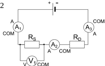
Le montage 2 comporte la même pile et la même résistance  $R_S$  que dans le montage 1. On ajoute la résistance  $R_D$  en série, identique à  $R_S$ . Les ampèremètres  $A_1$ ,  $A_2$  et  $A_3$  mesurent les intensités  $I_1$ ,  $I_2$  et  $I_3$ . On mesure la tension aux bornes de la résistance  $R_S$  avec le voltmètre  $V_1$ . Les valeurs mesurées sont positives.
