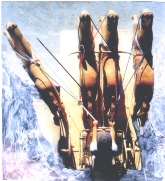
Figure 109 : Maquette au 1/5 du quadriga grec au galop, agencement des guides et principe utilisé pour tourner Spruytte
