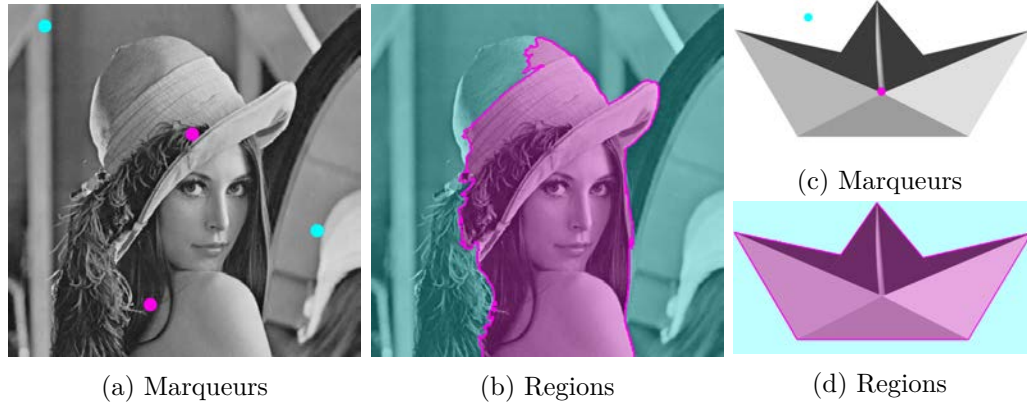
FIGURE 2.16 – Application des Power Watershed sur deux images de tests. En (a) et (c) le positionnement des marqueurs, avec en bleu ceux du fond et en rose ceux de l'objet à segmenter. En (b) et (d) le résultat de la segmentation équiprobable.
