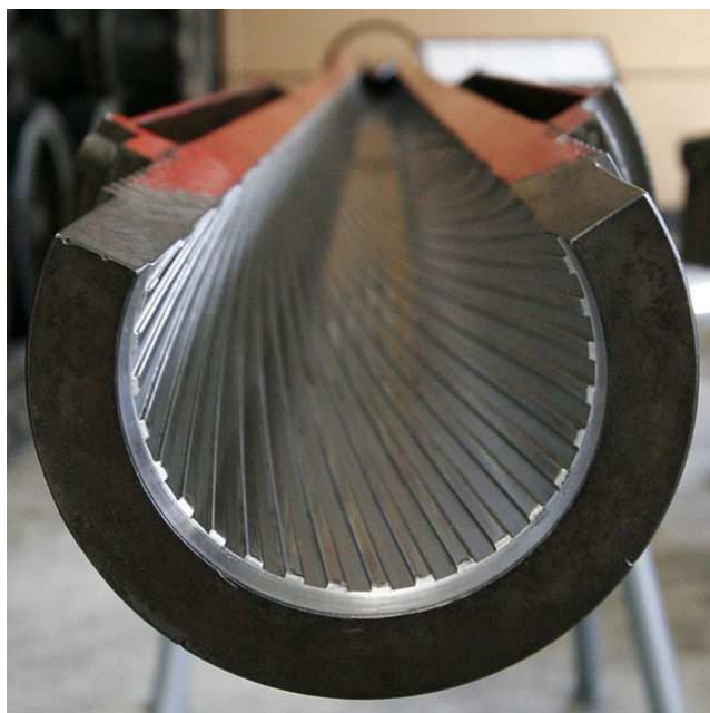
Figure 6.2 – Vue de l'intérieur d'un tube montrant la disposition des rayures.
