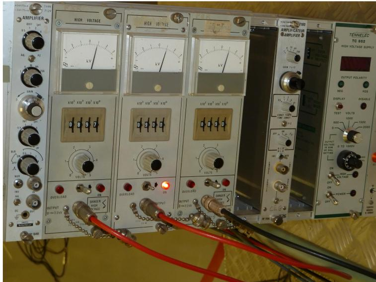
FIGURE 2.9 – Alimentations HT du dispositif expérimental
