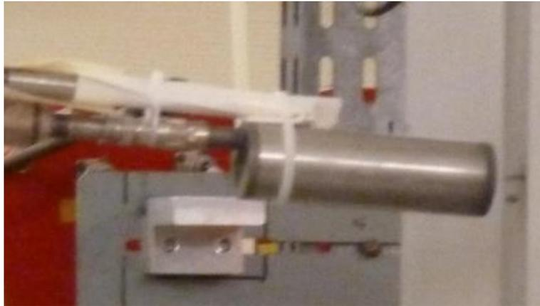
FIGURE 2.6 – Chambre à fission utilisée au SMNC
