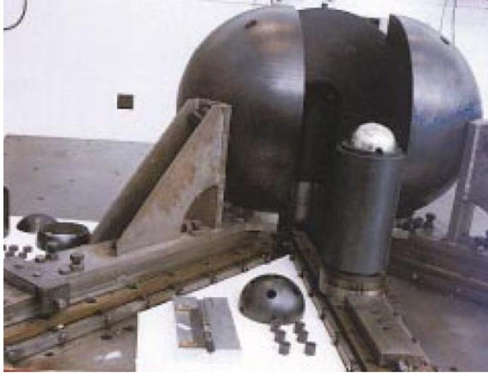
FIGURE 2.4 – *Le réacteur Flattop*
