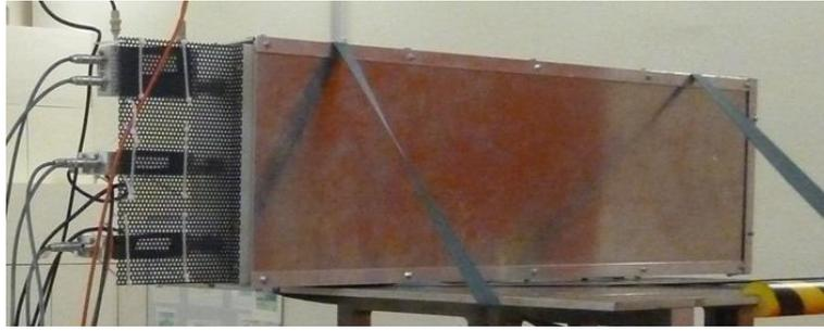
FIGURE 2.5 – Détecteur à Hélium 3 utilisé au SMNC
