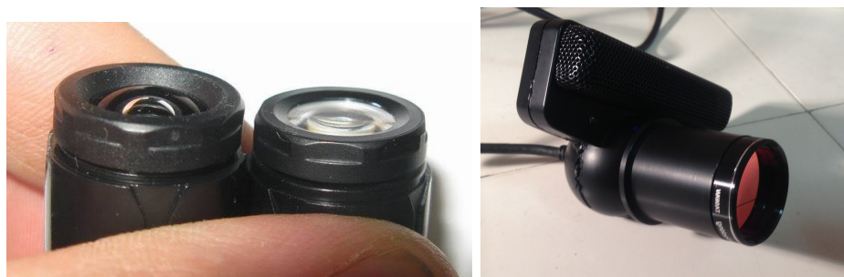
FIGURE 4.7 : Le capteur PS3Eye modifié et personnalisé en ajoutant un lentille télescopique
