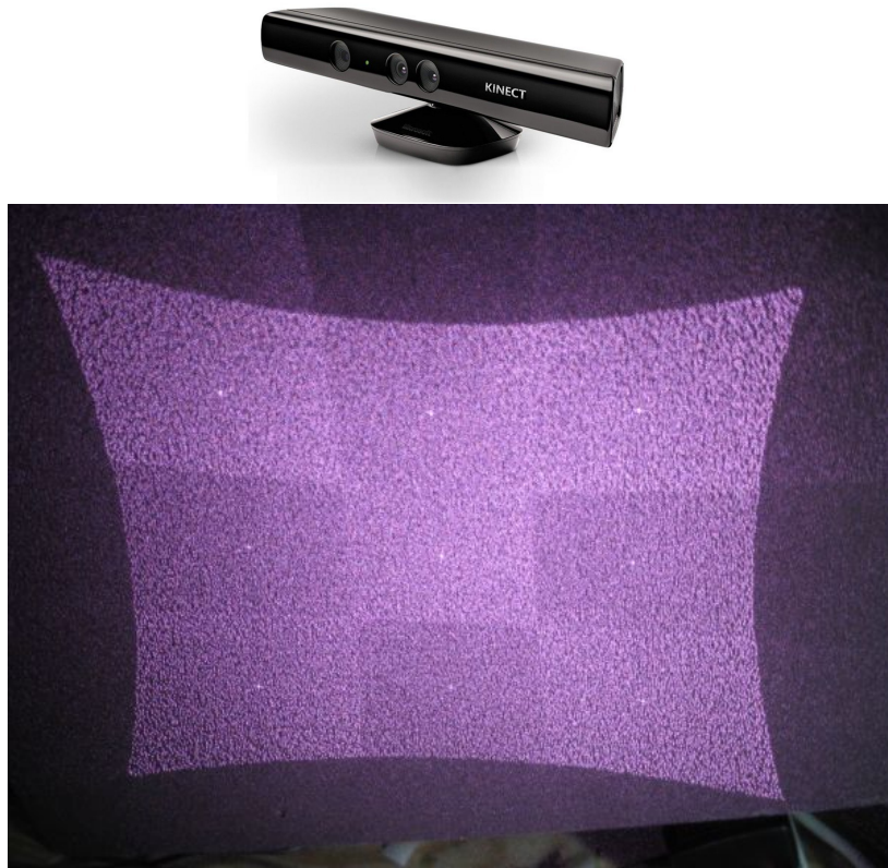
FIGURE 4.10 : La première version de la Kinect, et la visualisation du motif infrarouge émis et utilisé pour la capture 3D
