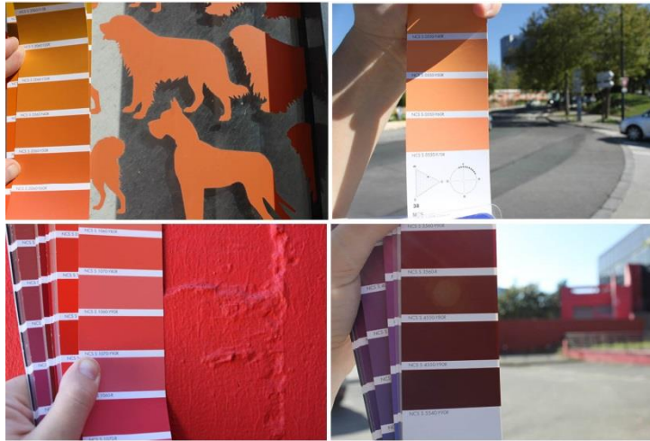
Figure 168, Observation des variations de couleurs des bâtiments. En haut : relevé des teintes de la clinique vétérinaire (réalisé par les architectes Tetrarc et Metalobil en 2006) sous le système de notation NCS. Les motifs de chiens en sérigraphie sont perçus de loin orange vifs. En bas : relevé des teintes du Palais des Sports de Beaulieu construit en 1979 par Evano-Pellerin. Illustration issue des photos prises sur le terrain d'enquête. Photos : Anne Petit, 2014.
