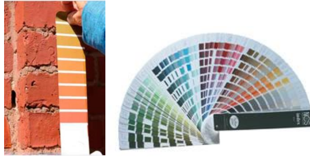
Figure 53, Méthode de relevé chromatique à l'aide d'un nuancier NCS 255
