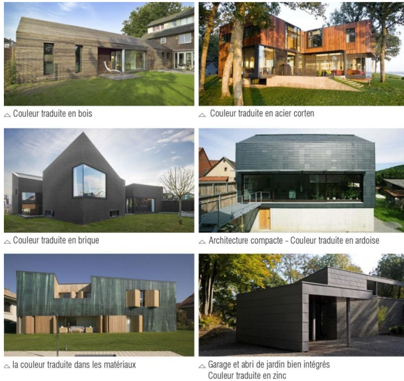
Figure 27, Illustration de certaines obligations du traitement coloré en façade des futures constructions contemporaines issue du CCCT de l'éco-quartier de la ZAC de La Pelousière créée en 2003 dans la commune de Saint-Herblain en Loire Atlantique 144
