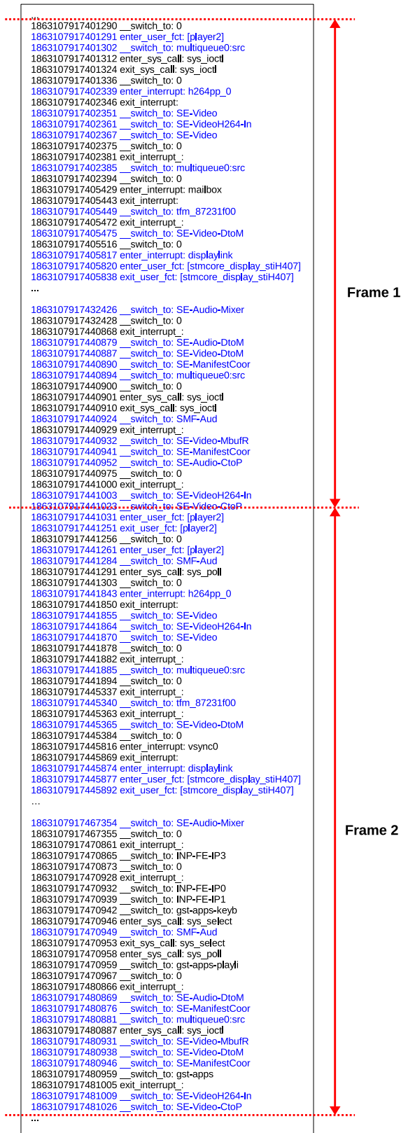
FIGURE 4.2 – Illustration des frames dans une trace. D = \{enter\_user\_fct:player2, \_switch\_to:multiqueue0:src, enter\_interrupt:h264pp\_0, \_switch\_to:SE-VideoH264-In, enter\_user\_fct:stmcore\_display\_stiH416, \_switch\_to:SE-Audio-Mixer\} est un exemple d'ensemble d'événements communs aux frames 1 et 2. Les éléments de D , présentés en couleur bleue dans la trace, représentent les événements liés au décodage audio-vidéo d'un flux vidéo.
