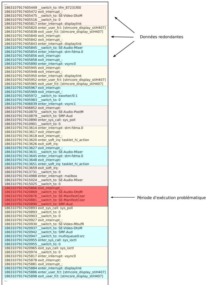
FIGURE 1.2 – Illustration des régimes de fonctionnement répétitifs et problématiques présents dans la trace d'exécution d'une application.
