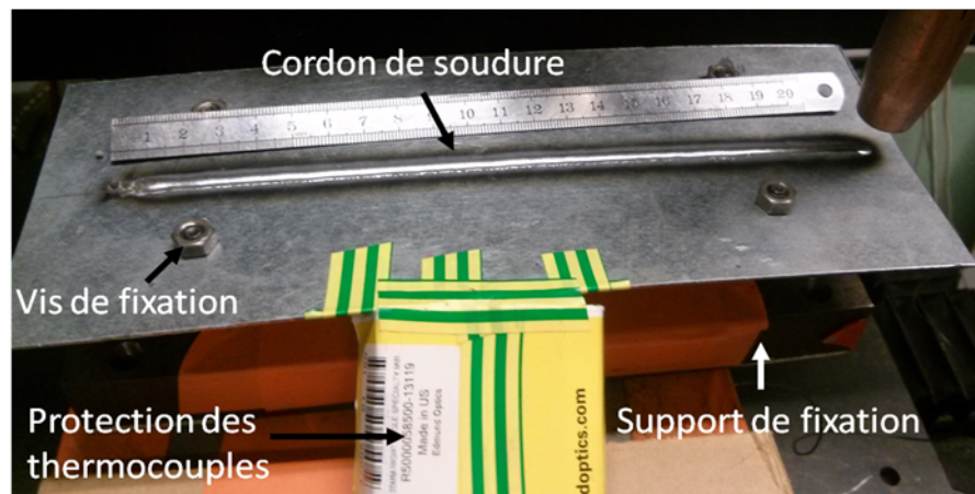
FIGURE V.2: Système de bridage de l'éprouvette.
