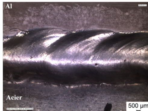
FIGURE III.7: (Cordon obtenu lors de l'essai 9 ( V_s=45 cm/min et P=356 W)).
