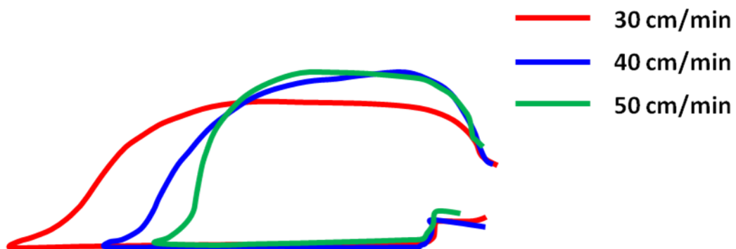
FIGURE III.18: Profils des cordons de soudure obtenus pour une même puissance et différentes vitesses de soudage (essais 4, 8 et 10).
