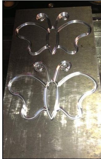
Figure 41 - Usinage d'une trajectoire B-spline sur la plateforme Sabre
