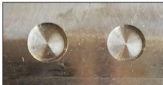
Figure 65 - Usinage perturbé-compensé à gauche et usinage non perturbé à droite
