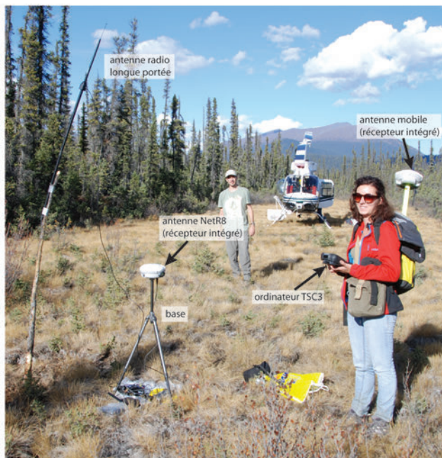
Figure 83 : Dispositif GPS RTK Trimble utilisé pour des levés topographiques.
