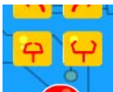
Figure 18 : icônes illustrant les fonctions " saisir avec la pince " et " relâcher avec la pince ".
