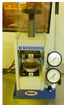
FIGURE 2.8 – a) Classification des techniques de soudure adaptée de [69] et de [68]. b) Photographie de la presse à chaud (Specac®) utilisée pour le soudage du PU.
