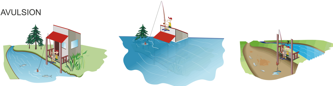
FIGURE 2.1 – Schéma montrant les différences entre une inondation et une avulsion. Suite à une inondation, le cours d'eau regagne son lit. Dans le cas d'une avulsion, il occupe un nouveau lit dans l'ancienne plaine d'inondation. Lors de l'avulsion décrite ici, le déclencheur de l'avulsion est une crue. D'autres phénomènes peuvent déclencher une avulsion (voir texte).
