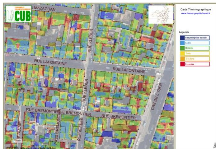
Figure 3 : Exemple de carte obtenue par thermographie infrarouge pour un quartier de Bordeaux (2009)
