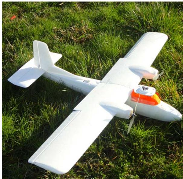
FIGURE 5.41 – Un Twinstar équipé d'une antenne Novatel
