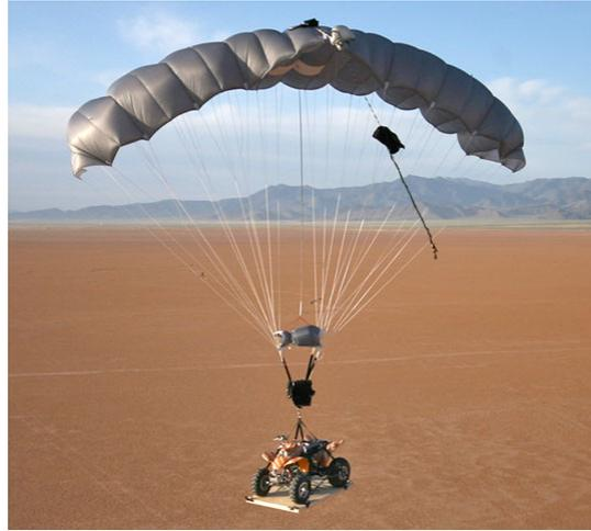
FIGURE 4.6 – Modèle de parafoil MP-360 de chez Onyx avec sa charge utile
