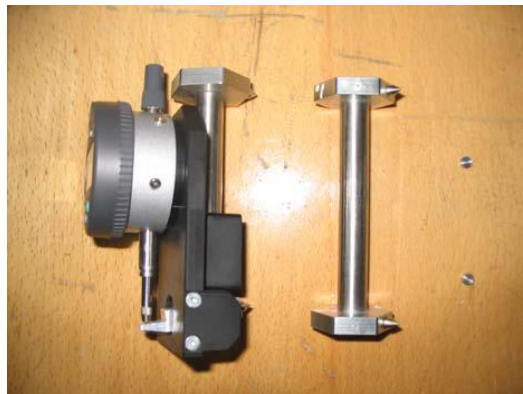
Figure 74 : Extensomètre à pointeaux + barre étalon [Martin 2010]
