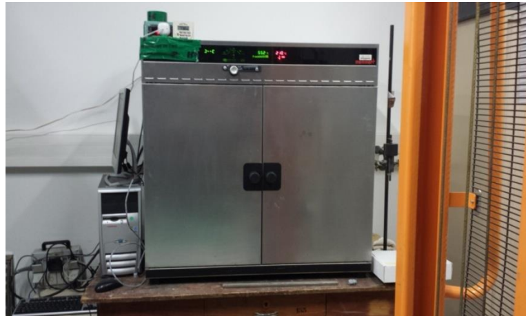
Figure A. 3: Etuve utilisée pour le test de validation des lois de couplage
