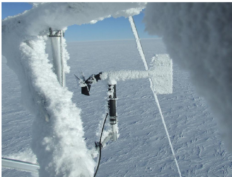
FIGURE 2.2 – Formation de givre à Dôme C sur le plateau d’Antarctique de l’Est. Source : Albane Barbero.
