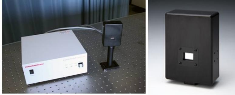
FIGURE 2.4 – **SLM à cristaux liquides** : une photographie du SLM utilisé pendant les expériences. À droite, détail de l'écran réfléchissant à cristaux liquides qui module en phase uniquement pour une polarisation horizontale de la lumière incidente.
