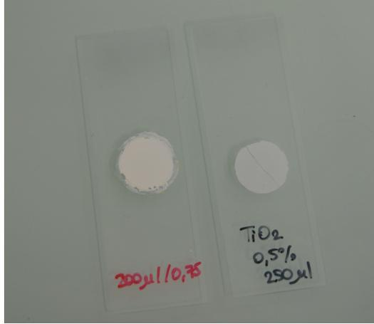
FIGURE 2.2 – **Échantillons utilisés dans les expériences** : l'échantillon de gauche est composé de 200  $\mu\text{L}$  d'une solution de concentration massique à 0,75% de  $\text{ZnO}$ . Celui de droite est composé de 250  $\mu\text{L}$  d'une solution de  $\text{TiO}_2$  à 0,5%.
