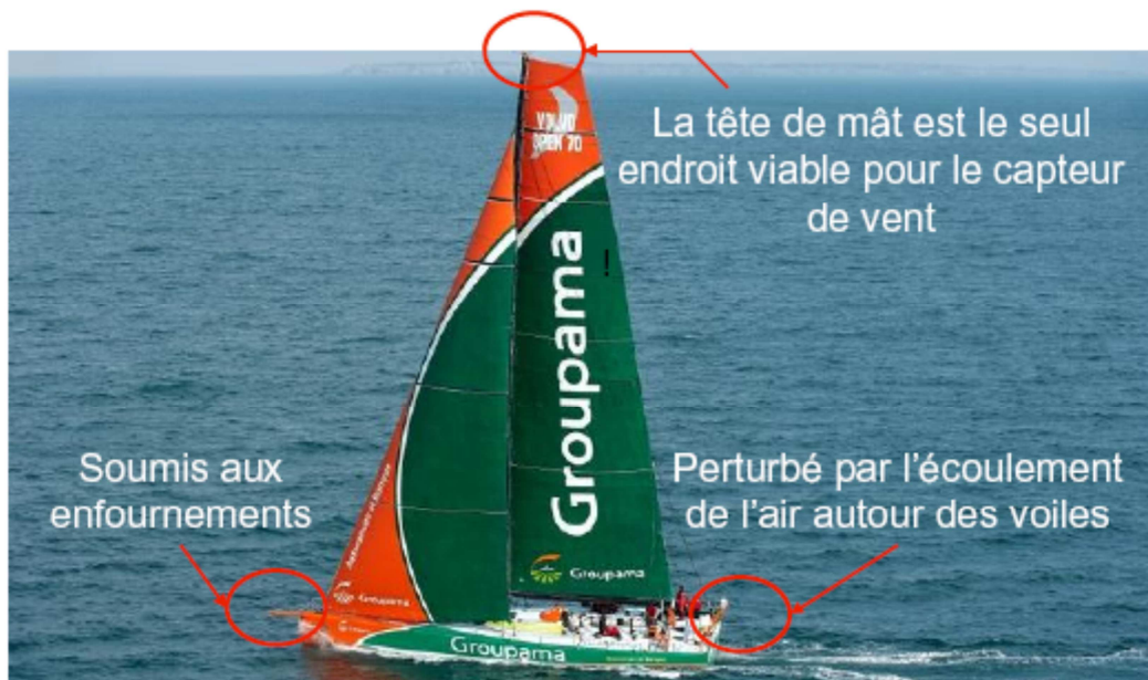
Figure 29: Positionnement du capteur de vent
