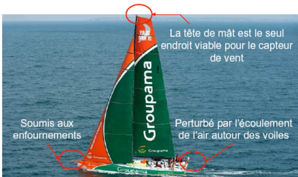
Figure 29: Positionnement du capteur de vent
