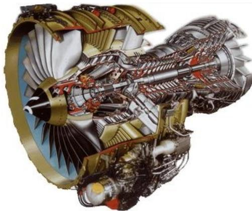
FIGURE 1.1: Coupe d'un CFM56-7B, moteur du Boeing 737.
