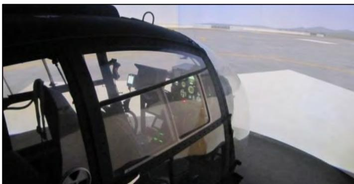
**Figure 5. Simulateur Gazelle FNPT 3.**
