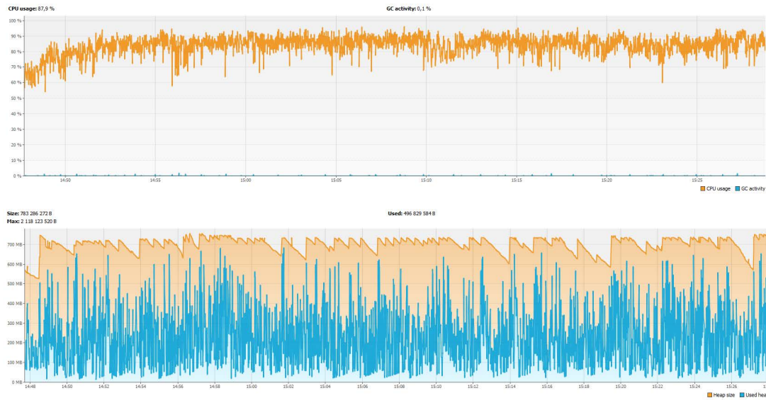
FIGURE 4.17 – Utilisation du CPU (en %, en haut) et de la mémoire (en MB, en bas) au cours de l'activité en mode "temps accéléré".
