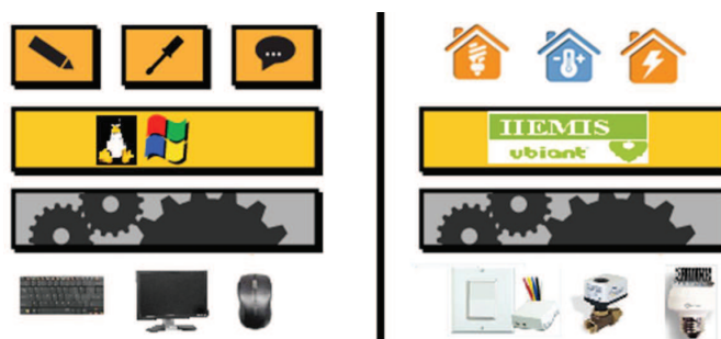
FIGURE 3.1 – Principe : le système HEMIS en tant que système d'exploitation de l'habitat.
