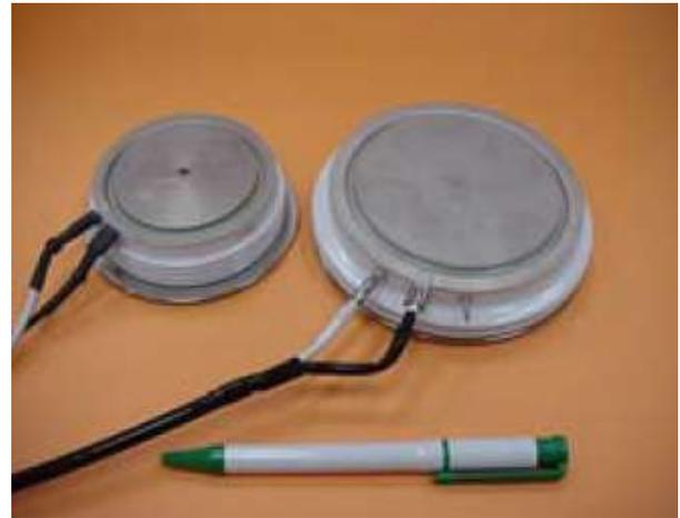
b. GTO en PressPack 4,5kV et 800A (gauche) - 1600A (droite)
