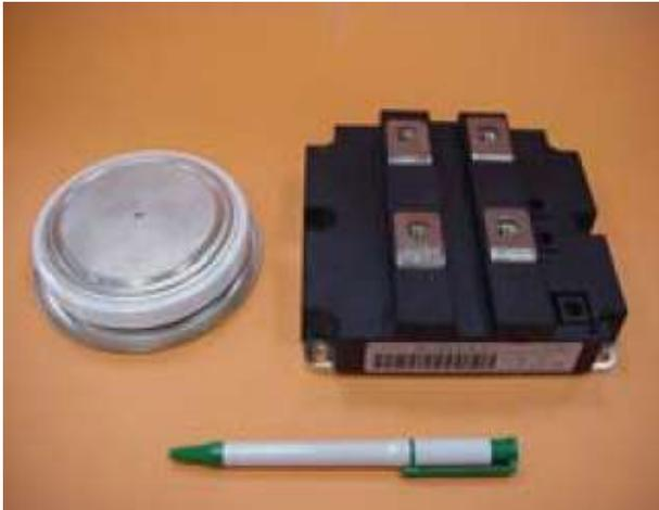
a. Diode de puissance en PressPack 4,5kV et 800A (gauche) - en module 1,7kV et 1,2kA (droite)
