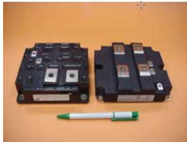
d. IGBT en module 1,2kA et 1,7kV (gauche) - 3,3kV (droite)
