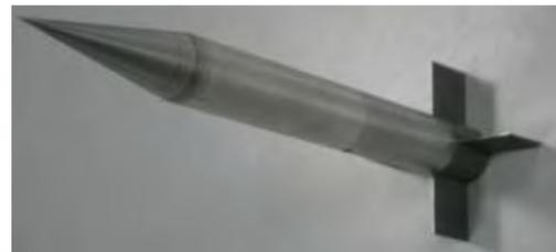
(b) Projectile aérostabilisé BASIC FINNER.
