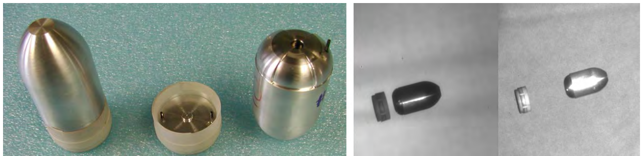
FIGURE 1.18 – Conception d'un sabot et séparation au cours du vol de ce dernier, d'après McMichael et al. [2].
