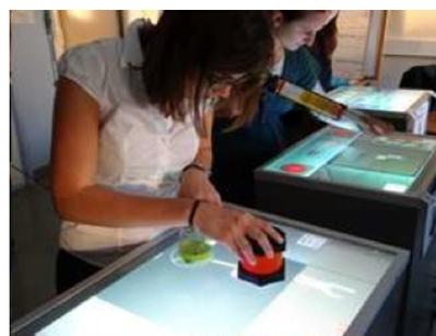
*Figure 15 : Interface tangible potentiomètre et pointeur sur table tactile*
