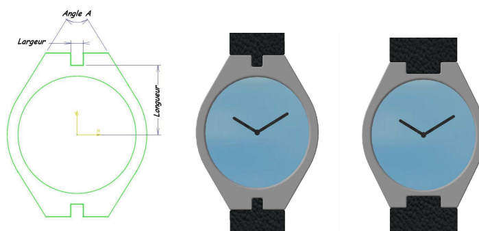
Figure B.4 – Génération de deux modèles CAO à partir d'une même esquisse
