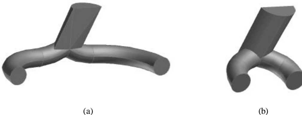
Figure IV-34. Enveloppe du collecteur d'échappement coté extérieur (a) et coté intérieur (b)
