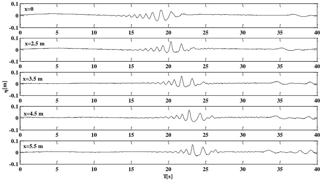
Figure III.2 : Evolution de la surface libre avec un courant inverse à la génération des houles courant avec  $f=0,75$  Hz dans différentes positions le long du canal.
