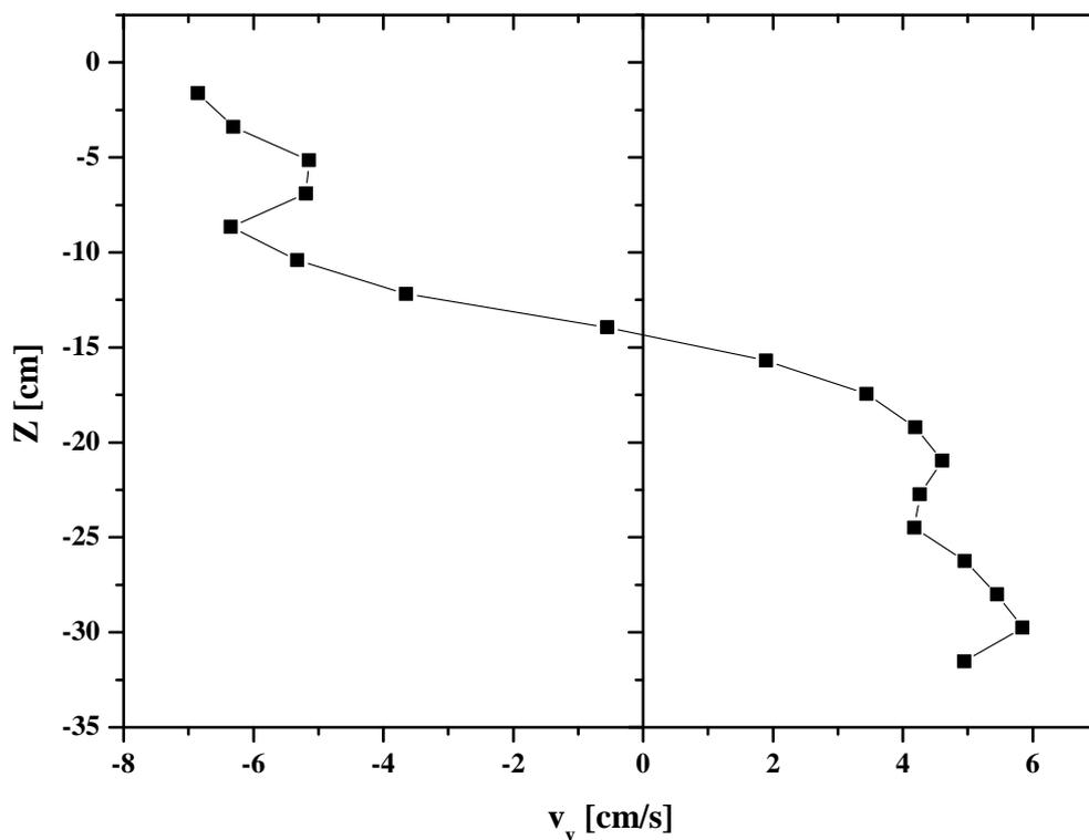
Figure IV.28: Profil vertical de la vitesse  $v_y$  de l'écoulement généré par les bulles d'air pour un  $Q=1,2 \cdot 10^{-3} \text{ m}^3/\text{s}$  (section a-b).
