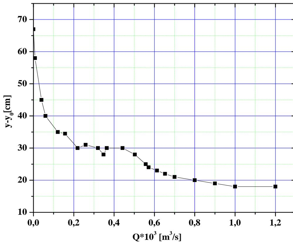
Figure IV.2.b : Coordonnées du point de déferlement en fonction du débit d'air ( $y_0=13m$ ),
