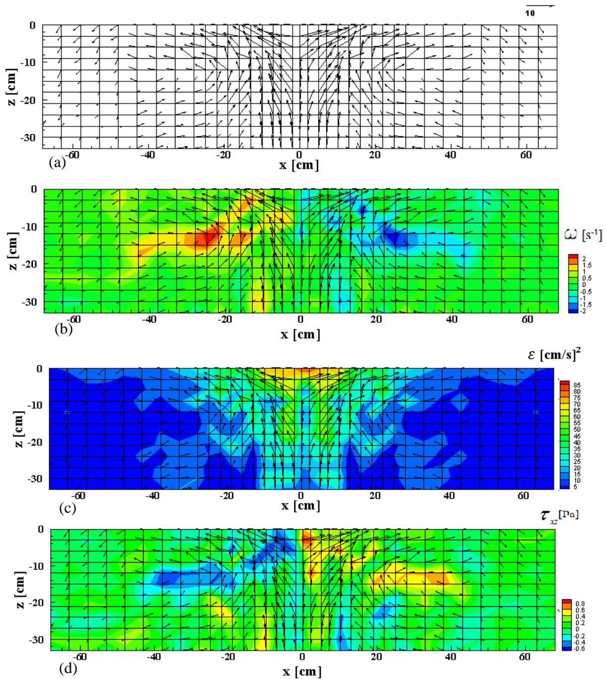
Figure IV.22 : Caractéristiques d'écoulement (a) : champs de vitesse, (b) : vorticité, (c) : densité énergétique, (d) : taux de cisaillement pour un débit d'air  $Q=0,8.10^{-3} \text{ m}^3/\text{s}$  à  $t_0$ .
