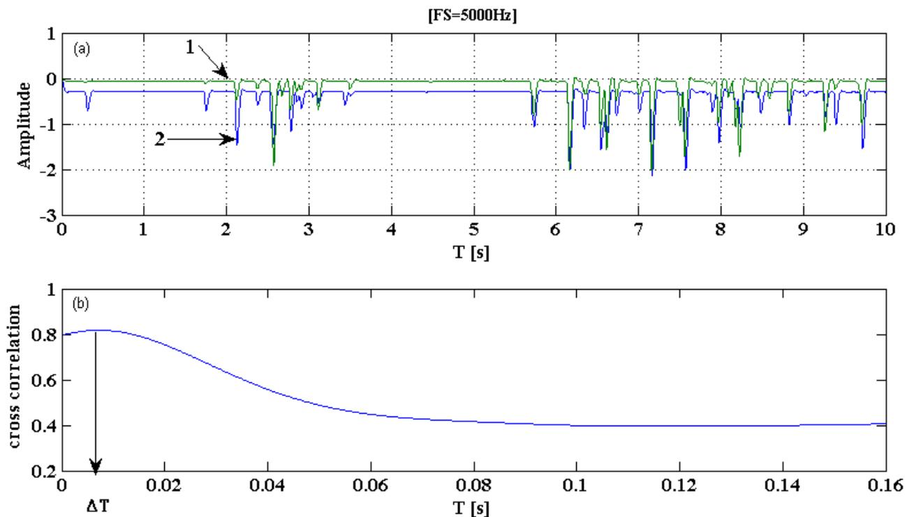
Figure II.19 : Exemple des signaux traités par Matlab. (a) : deux signaux correspondant au double pic des sondes conductives, (b) un exemple de CCF entre les deux signaux.
