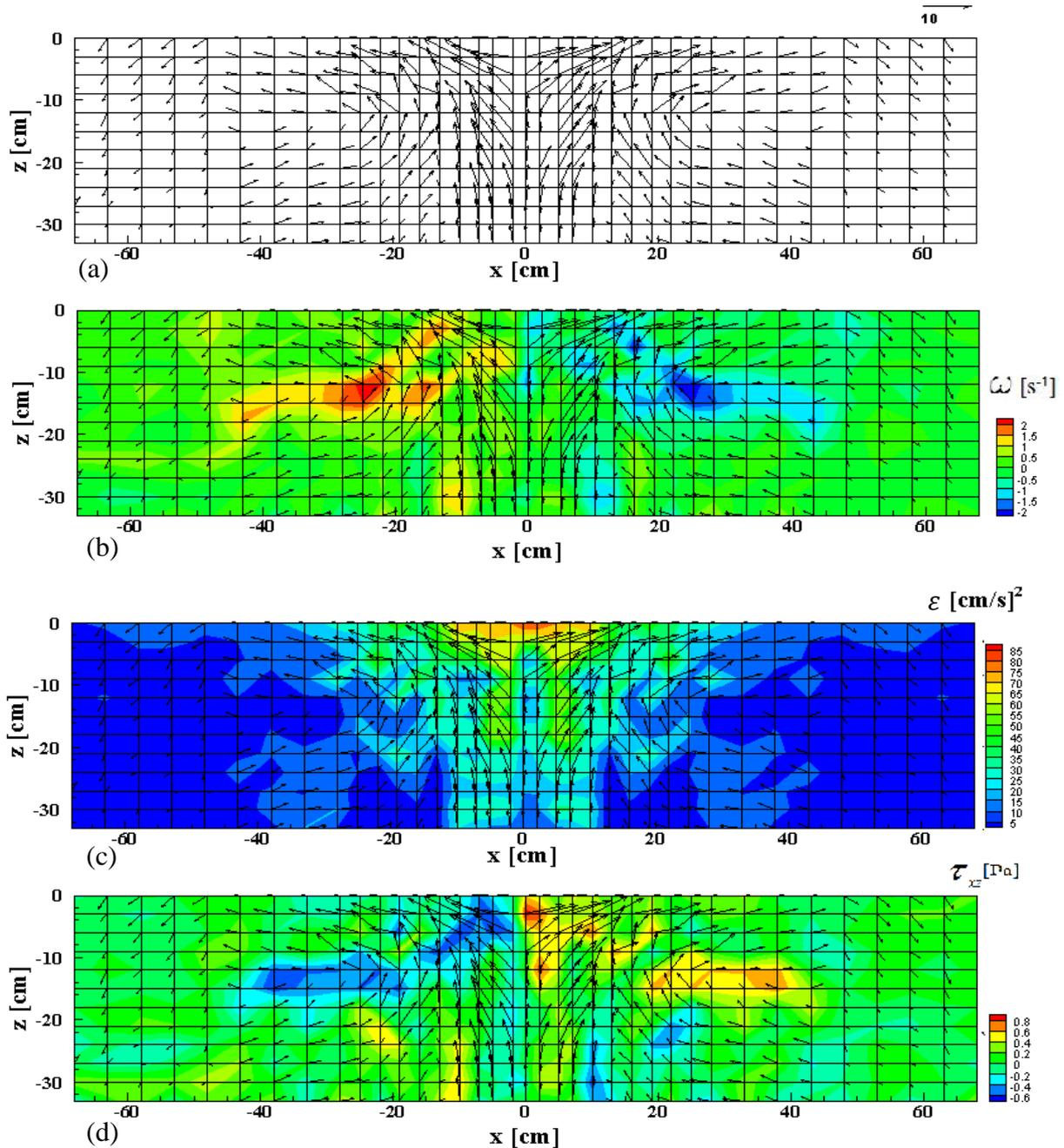
Figure IV.21: Caractéristiques d'écoulement (a) : champs de vitesse, (b) : vorticité, (c) : densité énergétique, (d) : taux de cisaillement pour un débit d'air  $Q=0,4 \cdot 10^{-3} \text{ m}^3/\text{s}$  à  $t_0$ .
