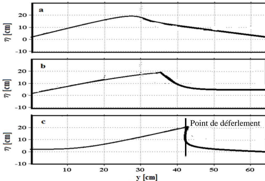
Figure IV.1 : Elévation de la surface libre  $\eta$  en fonction de la distance horizontale  $y$  sur la position étudiée.
