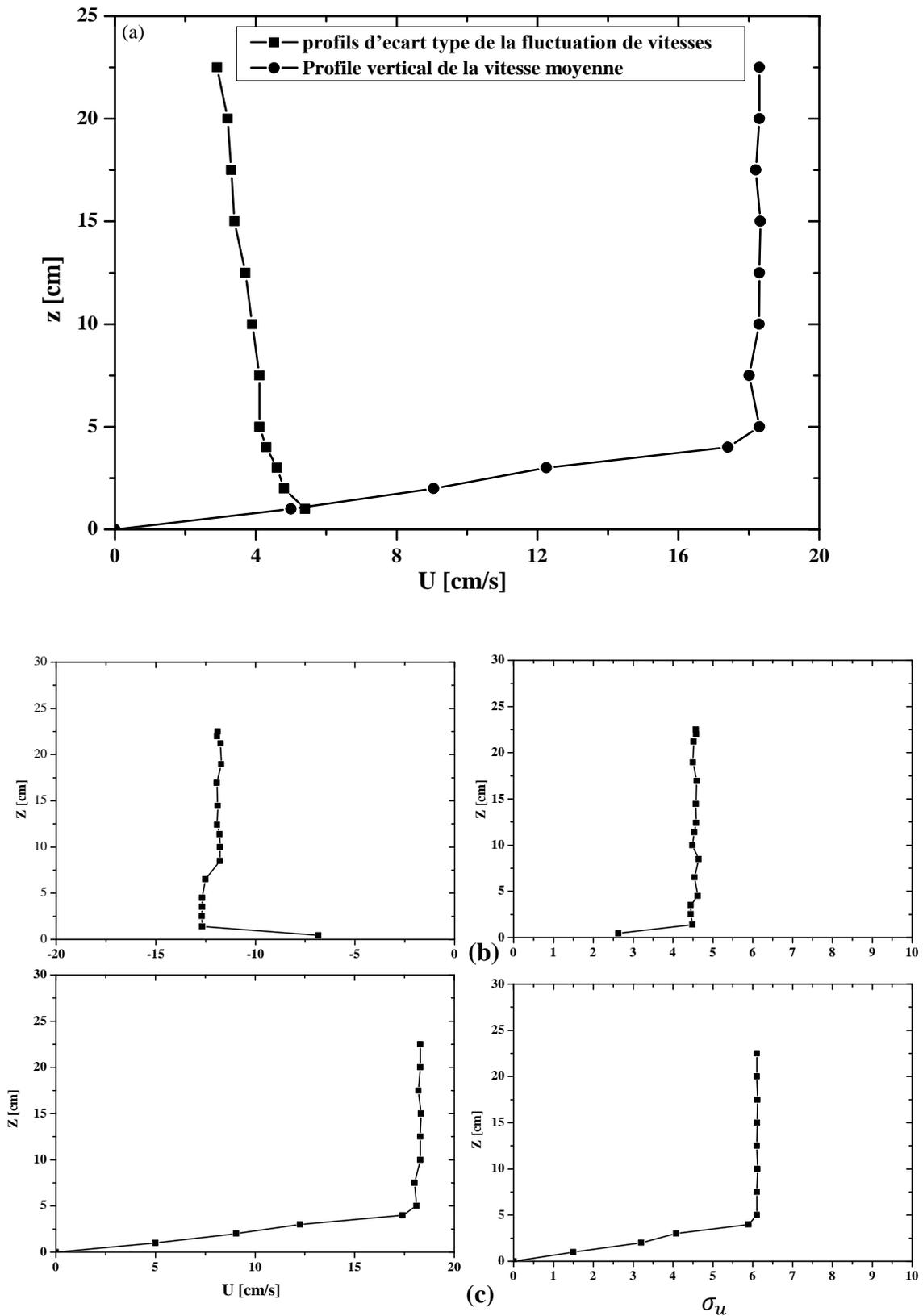
Figure III.6 : (a) Profil de l'écart type de la fluctuation de vitesse et le profil de la vitesse moyenne à 3 m du batteur, (b) Profils de vitesse pour un courant négatif au voisinage du batteur (c) Profils de vitesse pour un courant positif au voisinage du batteur
