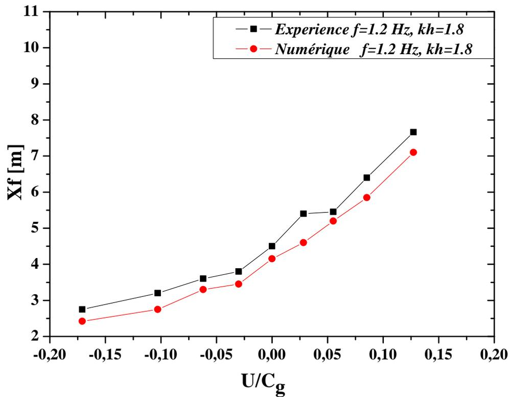
Figure III.14 : Comparaison entre les résultats numériques et expérimentaux de l'évolution de la distance de focalisation en fonction des vitesses du courant pour une fréquence  $f=1,2$  H, Merkoune et al [2013].
