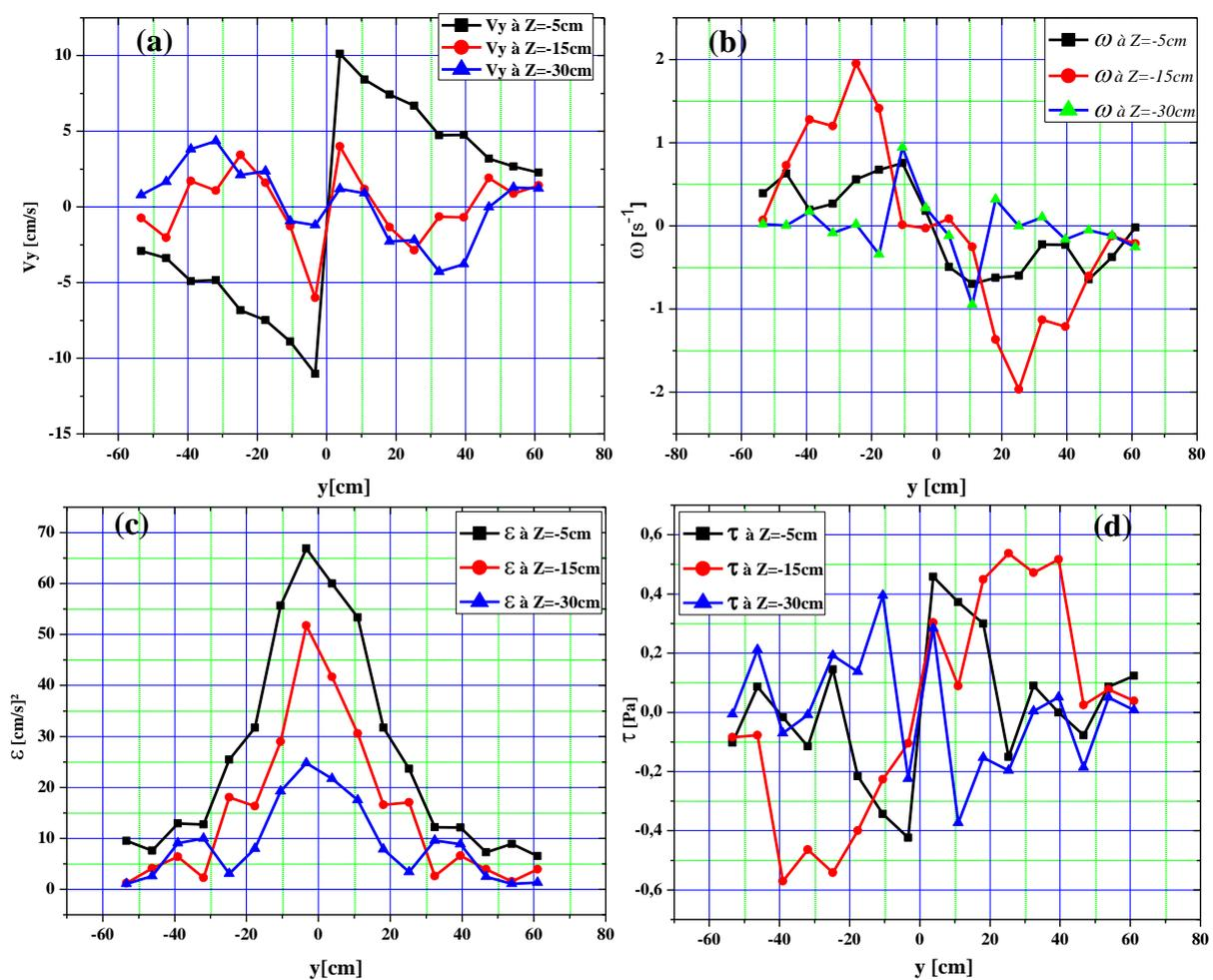
Figure IV.25: Profils horizontaux des paramètres d'écoulement : (a) : profils de vitesses  $v_y$ , (b) : profils de vorticités, (c) : profils de densités d'énergie, (d) : profils de taux de cisaillement.
