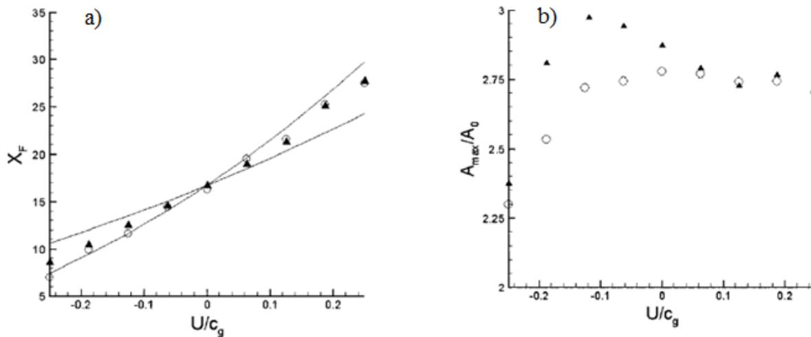
Figure I.10 :a) Variation de la position du point de focalisation en fonction de la vitesse du courant. b) : Variation de l'amplitude du point de focalisation en fonction de la vitesse du courant (Touboul et al [2007]).
