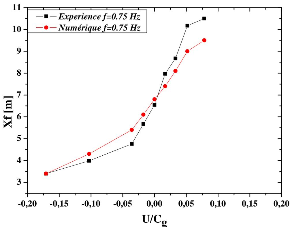
Figure III.15 : Comparaison entre les résultats numériques et expérimentaux de l'évolution de la distance de focalisation en fonction des vitesses du courant pour une fréquence  $f=0,75\text{Hz}$ , Merkoune et al [2013].
