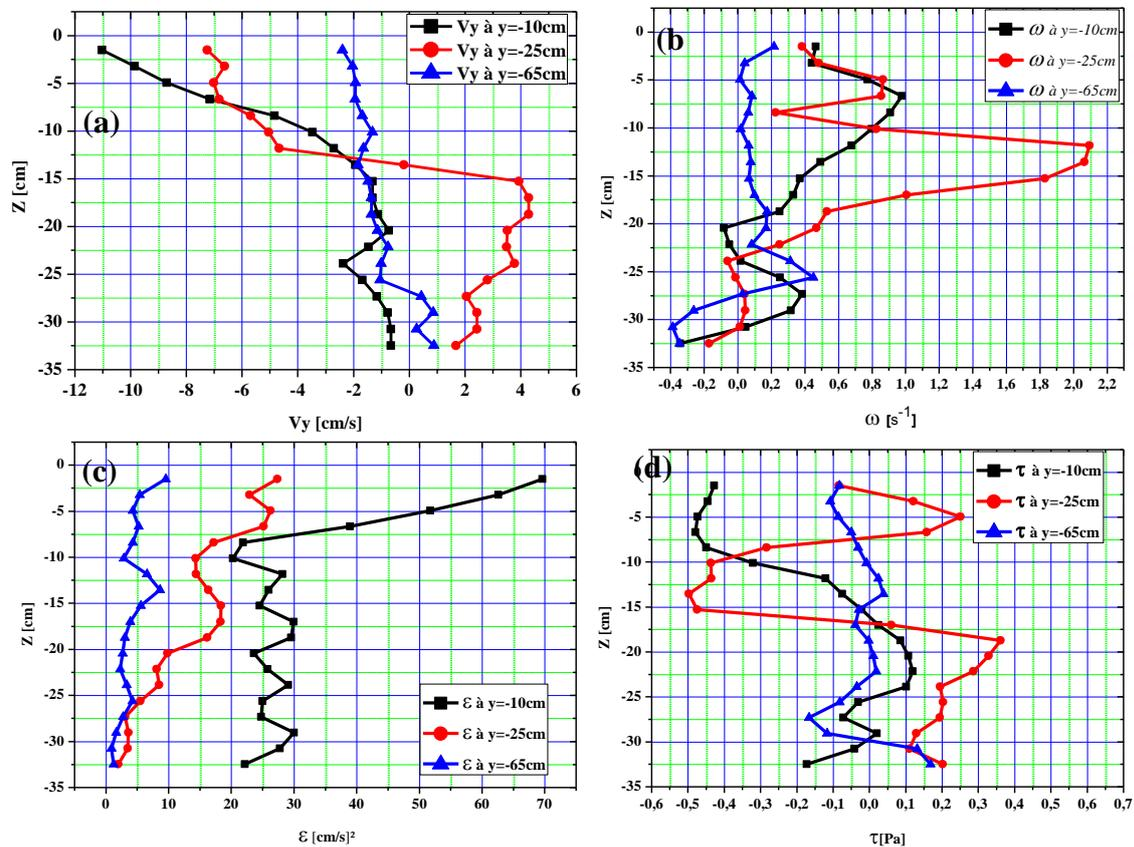
Figure IV.26 : Profils verticaux des paramètres d'écoulement : (a) : profils de vitesses  $v_y$ , (b) : profils de vorticités, (c) : profils de densités d'énergie, (d) : profils de taux de cisaillement.
