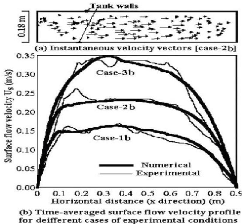
Figure I.20 : Comparaison entre les résultats numériques et expérimentaux pour des profils de vitesses d'écoulement moyen à la surface libre (Abdulmouti [2011]).
