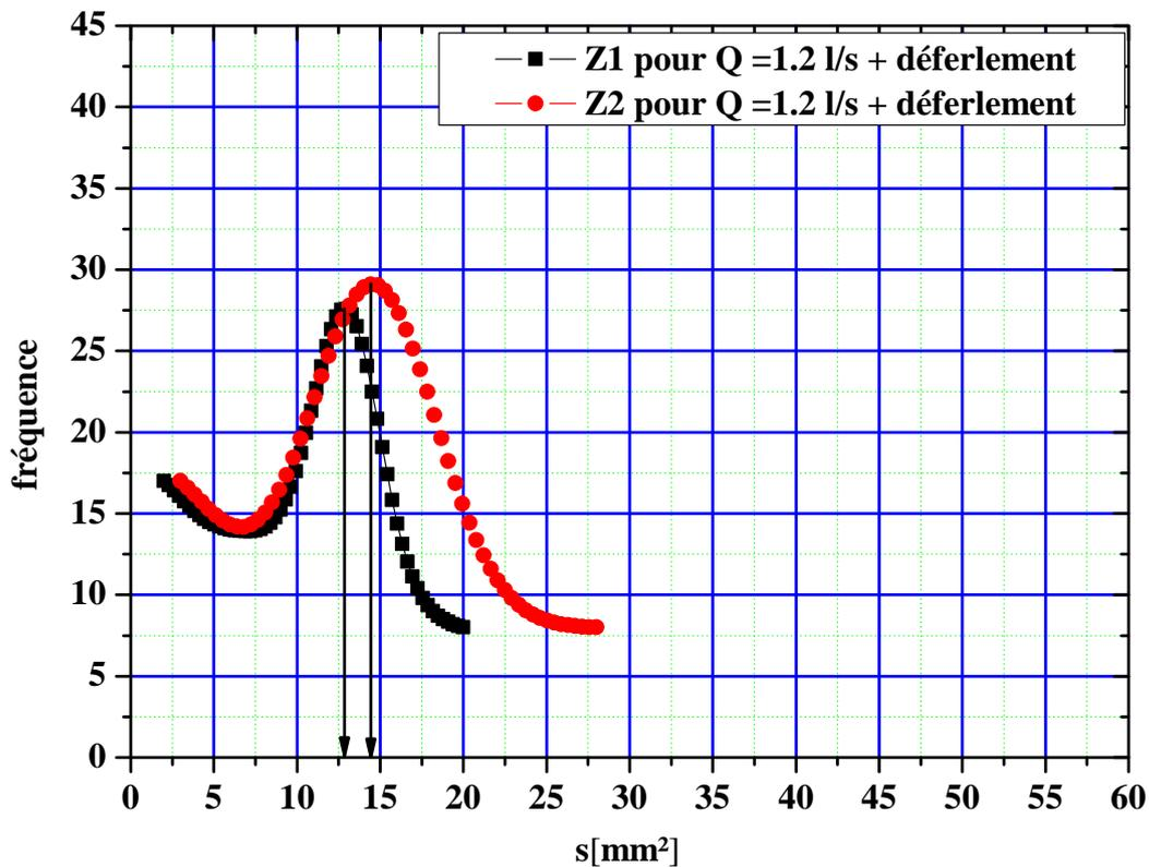
Figure IV.16 Distribution des bulles d'air avec un débit  $Q=1,210^{-3} \text{ m}^3/\text{s}$  avec déferlement.
