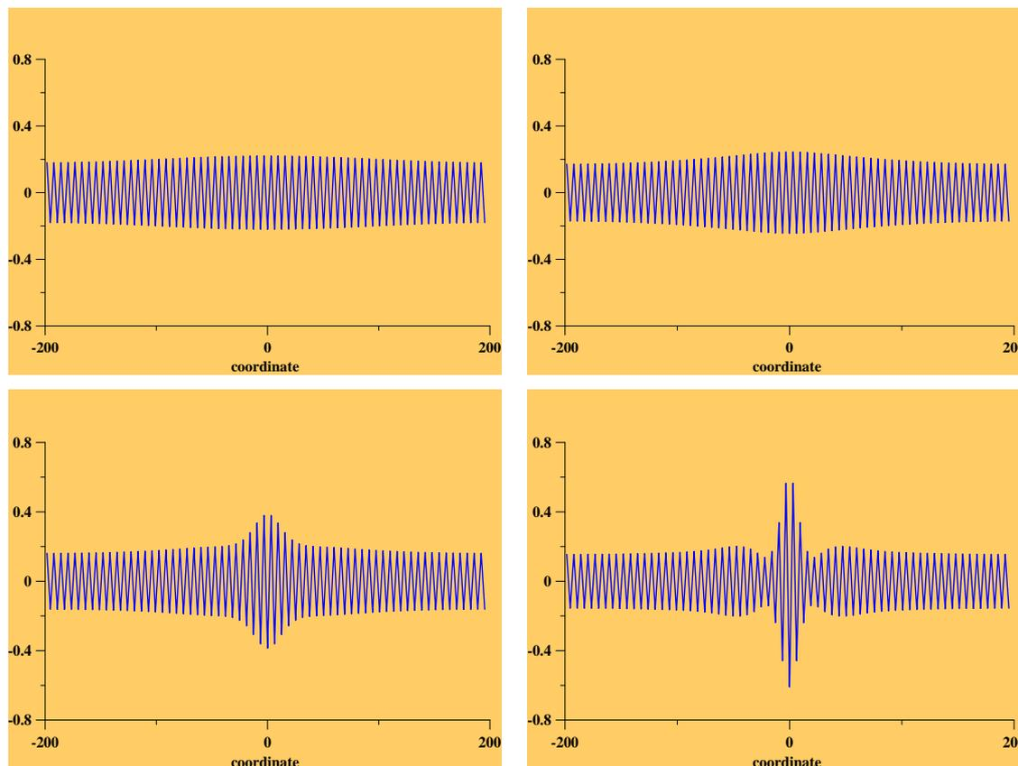
Figure I.5 : Evolution spatio-temporelle d'une instabilité modulationnelle
