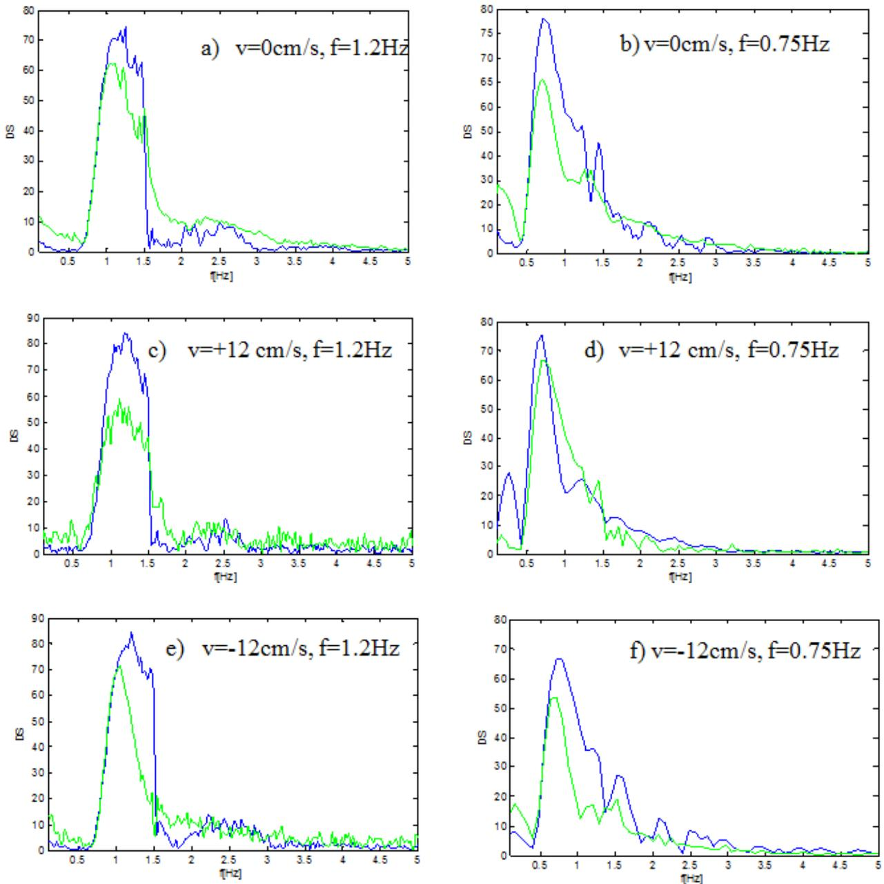
Figure III.7 : Densité spectrale pour les deux fréquences  $f=0,75\text{Hz}$   $f=1,2\text{Hz}$ . La ligne bleue correspond à la densité énergétique du batteur à  $x=2\text{ m}$ . La ligne verte correspond à la densité énergétique à  $x=6\text{ m}$  du batteur.
