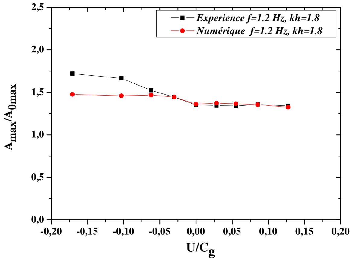
Figure III.11 : Evolution de l'amplitude de focalisation pour  $f=1,2$  Hz,
