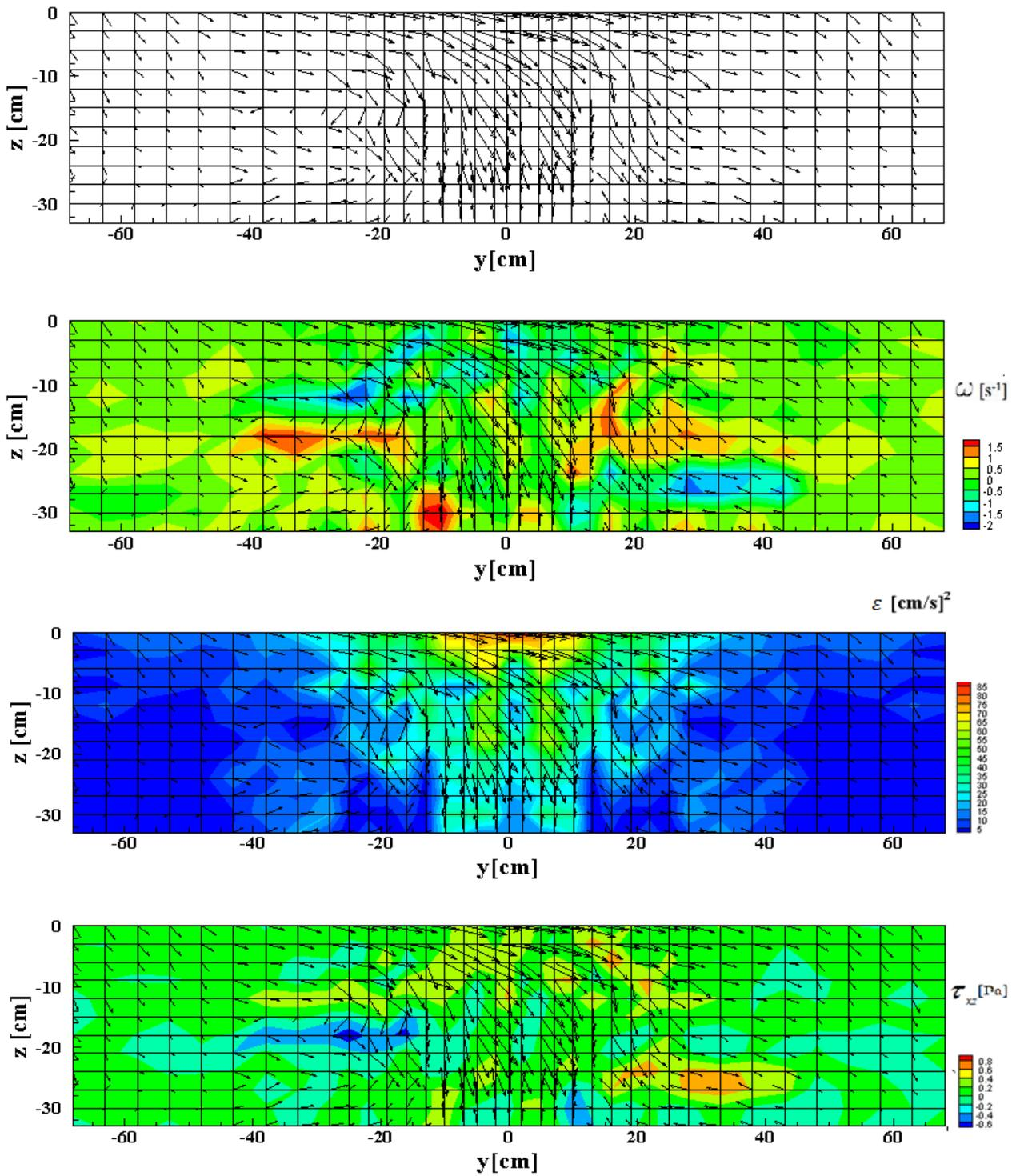
Figure IV.24: Caractéristiques d'écoulement (a) : champs de vitesse, (b) : vorticit , (c) : densit   nerg tique, (d) : taux de cisaillement pour un d bit d'air  $Q=0,4 \cdot 10^{-3} \text{ m}^3/\text{s}$     $t_4$ .
