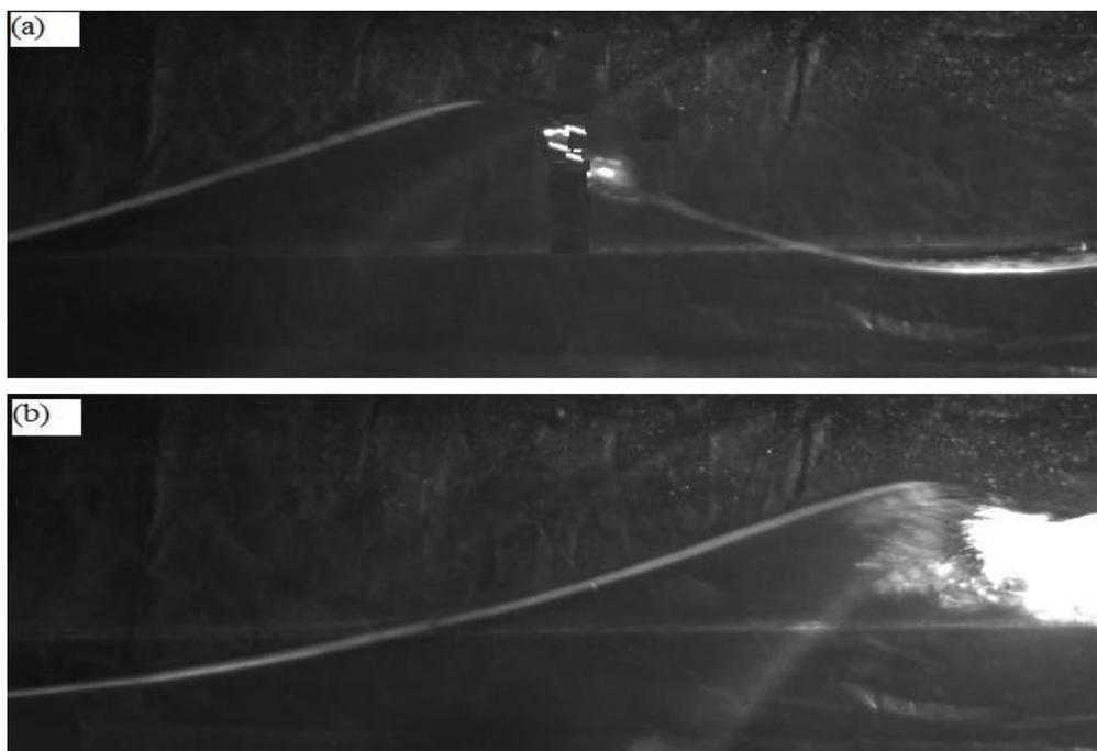
*Figure II.11 : Photos représentant le processus de déferlement avec la caméra rapide en  $\Delta T = 0,025$  s.*
