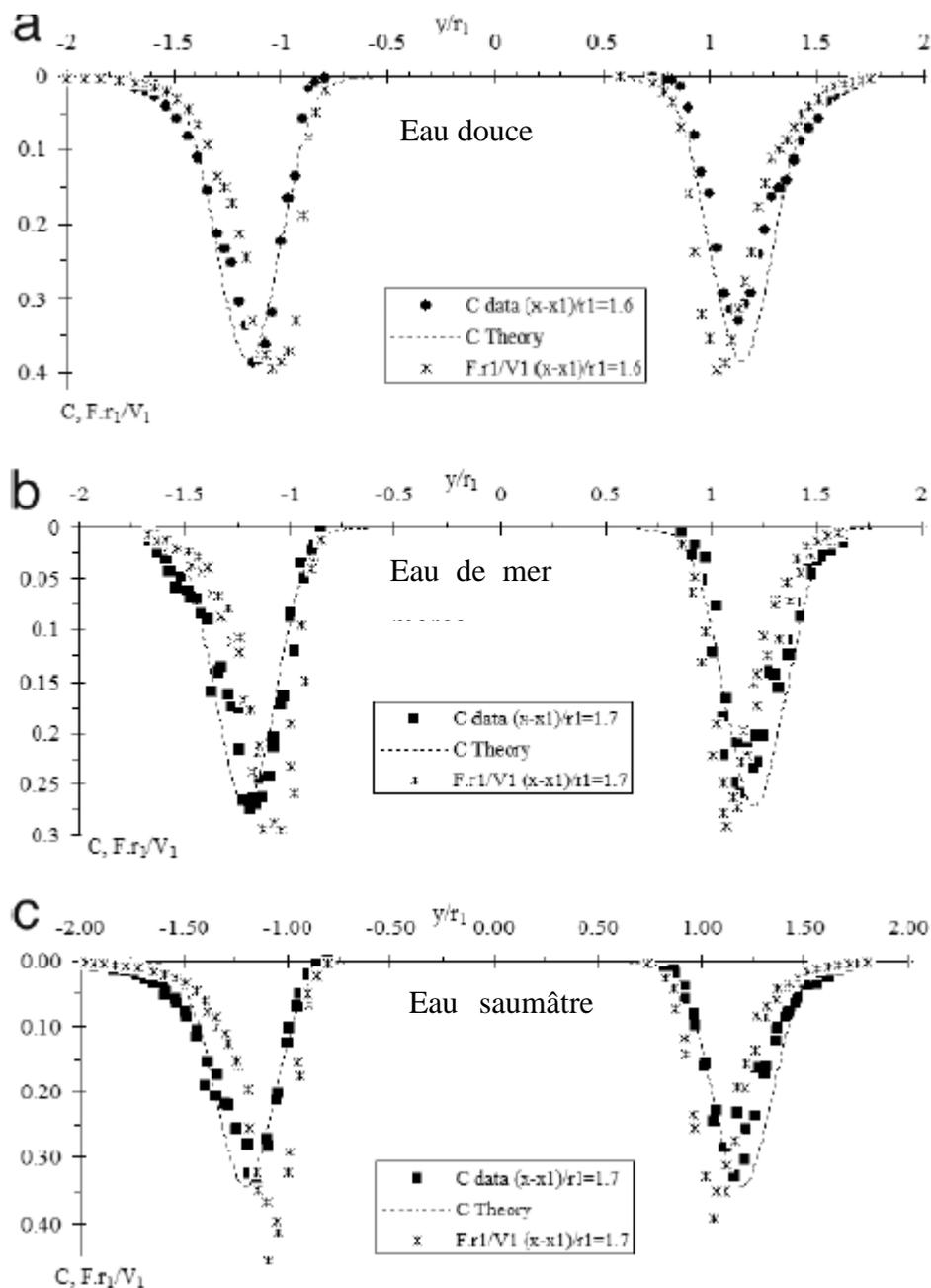
Figure I.17 : Distribution de la fraction de vide en fonction du facteur adimensionnel  $Fr_1/V_1$ , a) l'eau douce, b) l'eau de mer, c) l'eau saumâtre (Chanson [2006]).
