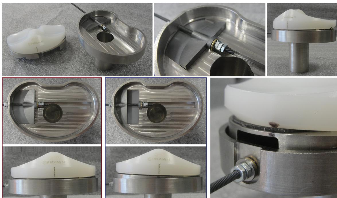
FIGURE 5.1 – le prototype en acier du composant tibial instrumenté
