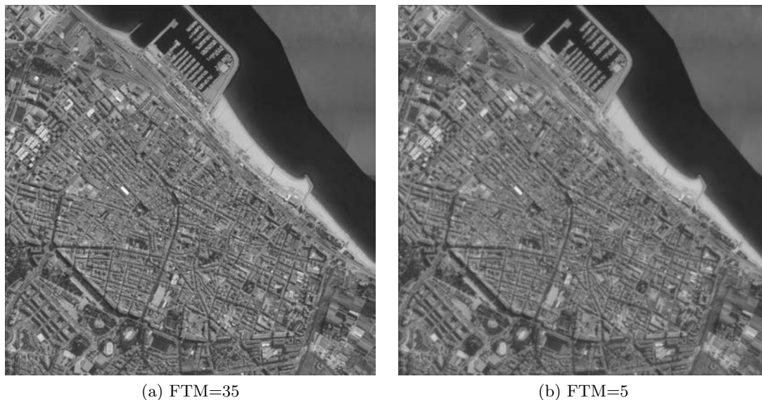
FIGURE 5.1 – Image test : Mataro (1024x1024) pour deux valeurs de FTM : FTM=35 (a) et FTM=5 (b). Images 8 bits en niveaux de gris.
