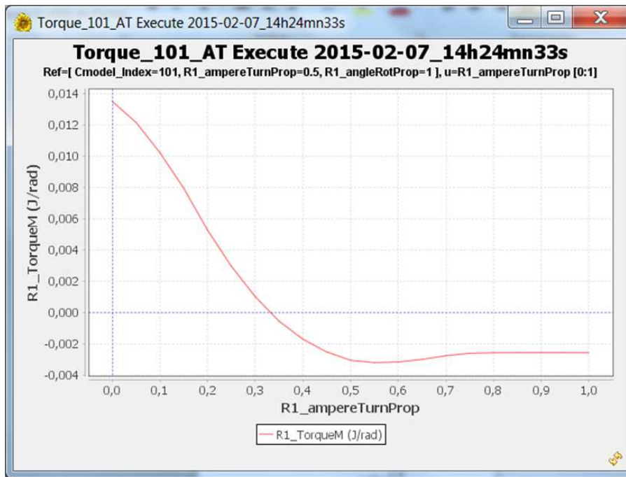
FIGURE 5.16 – Évolution du couple sur la partie mobile en fonction des ampères-tours pour la configuration 101.
