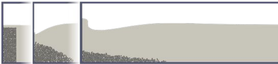
FIGURE E.2. – Couplage LBM/DEM : effondrement d'une colonne de grains à différents temps ( T = 0 , T = 0.04 et T = 0.08 ).
