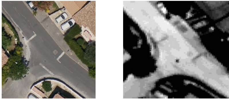
FIGURE 3.3. – Exemple d’avaloir et bouche d’égout sur une image à 5cm de résolution en couleurs naturelles (gauche) et à 40cm de résolution en thermique (droite). L’avaloir apparaît nettement plus sombre, donc plus froid, que la route.
