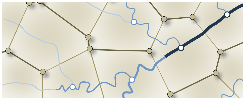
FIGURE 108 : Différentes trajectoires raffinées en fonction de leur type de Rosgen. Les courbes montrées sont de types B (bleu clair), G (bleu moyen) et D (bleu foncé).
