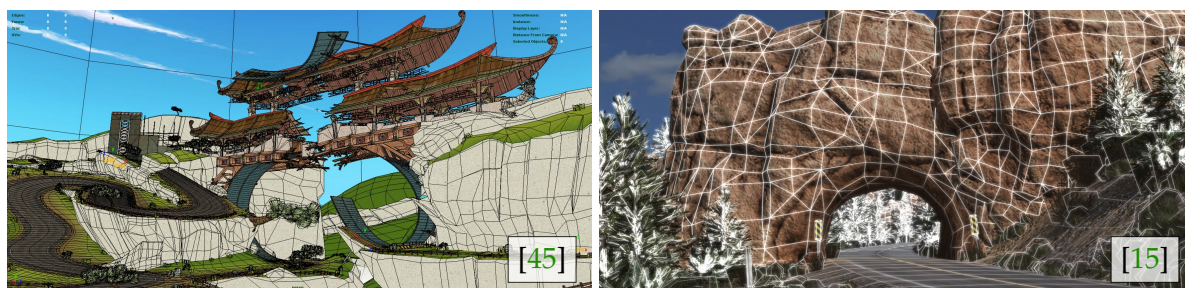
FIGURE 12 : Souvent, les maillages 3D classiques sont utilisés pour représenter des objets dans le relief du terrain. Ces structures non-spécialisées coûtent plus cher en mémoire et ne sont pas forcément adaptées aux différentes simulations de phénomènes naturels.
