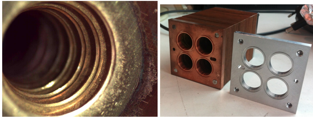
FIGURE 4.18 – à gauche Dorure déposée par électrolyte à l'intérieur d'un des cornets. à droite les deux plaques avant corruguées réalisées par l'observatoire de Paris. La pièce en cuivre est montée sur le prototype.
